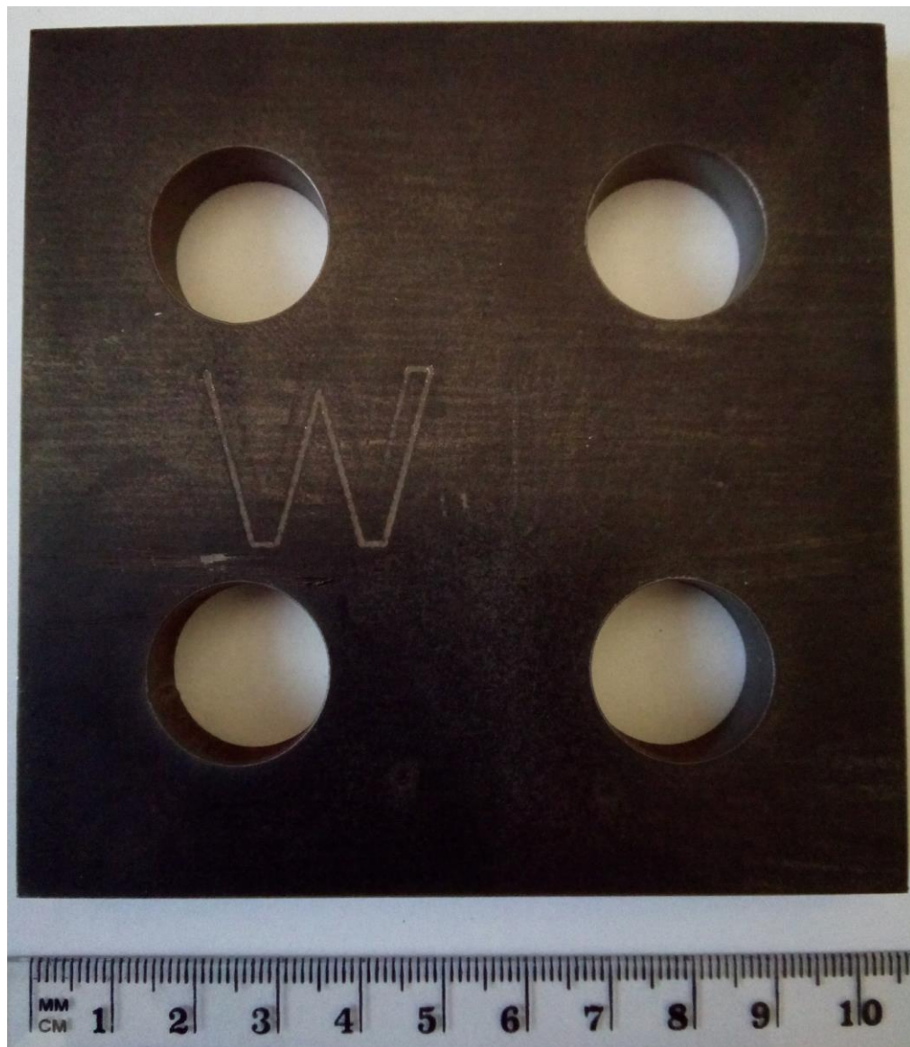
Slika 27. Obradak nakon obrade abrazivnim vodenim mlazom
