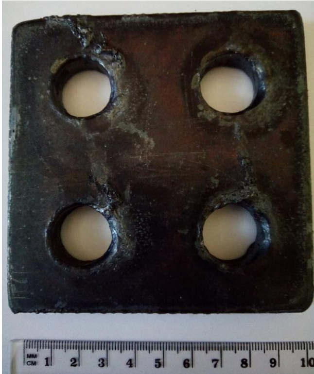
Slika 23. Obradak nakon obrade plazmom, gornja površina
