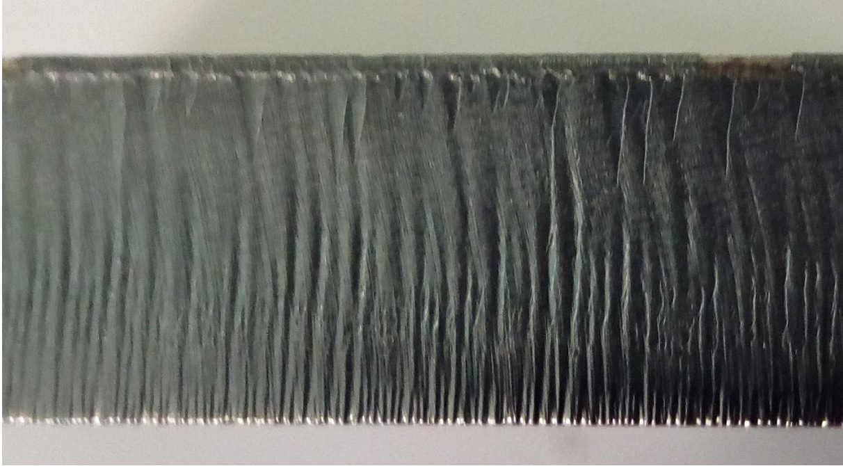
Slika 21. Prikaz bočne površine obratka nakon laserskog rezanja
