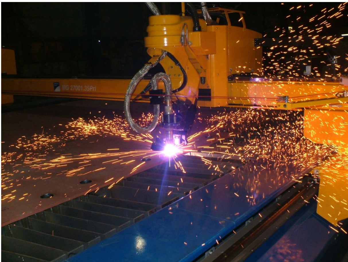
Slika 4. CNC stroj za rezanje plazmom, [13]
