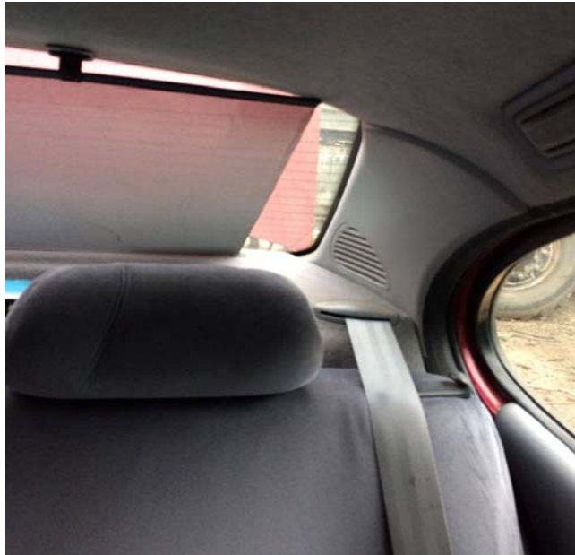
Slika 11. Predodžba zadnjeg lijevog „C“ stupa
