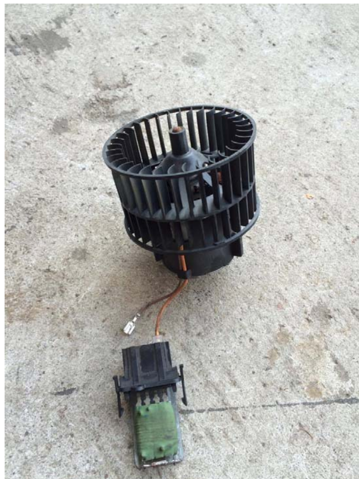
Slika 24. Predodžba otpornika i ventilatora kabine
