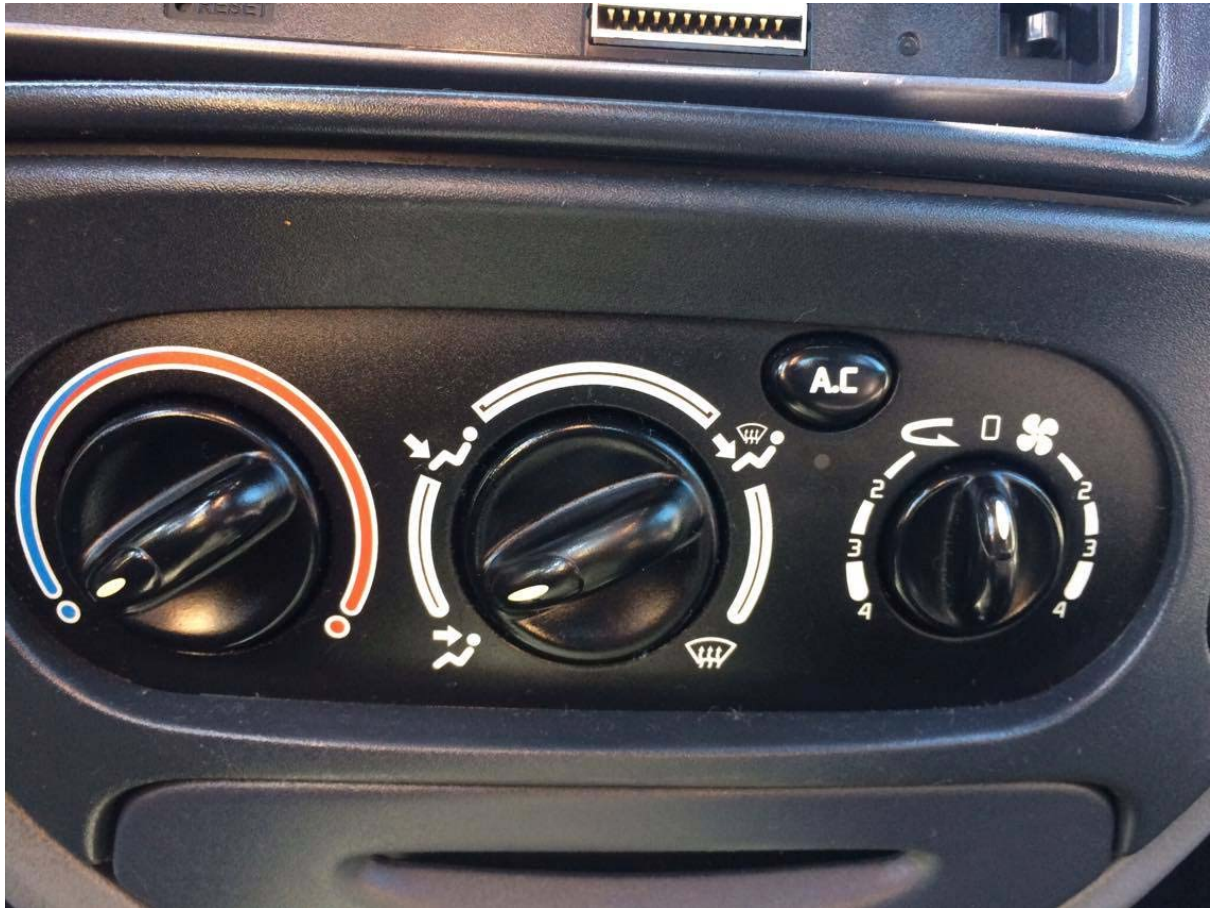
Slika 23. Predodžba potrebnog položaja prekidača ventilacije
