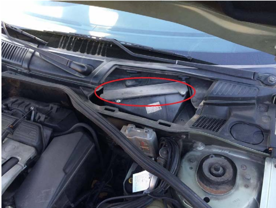
Slika 9. Predodžba usisa zraka i mjesto peludnog filtra
