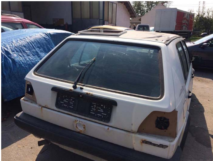
Slika 33. Predodžba dodatnih ventilatora ugrađenih na mjesto zadnjih farova
