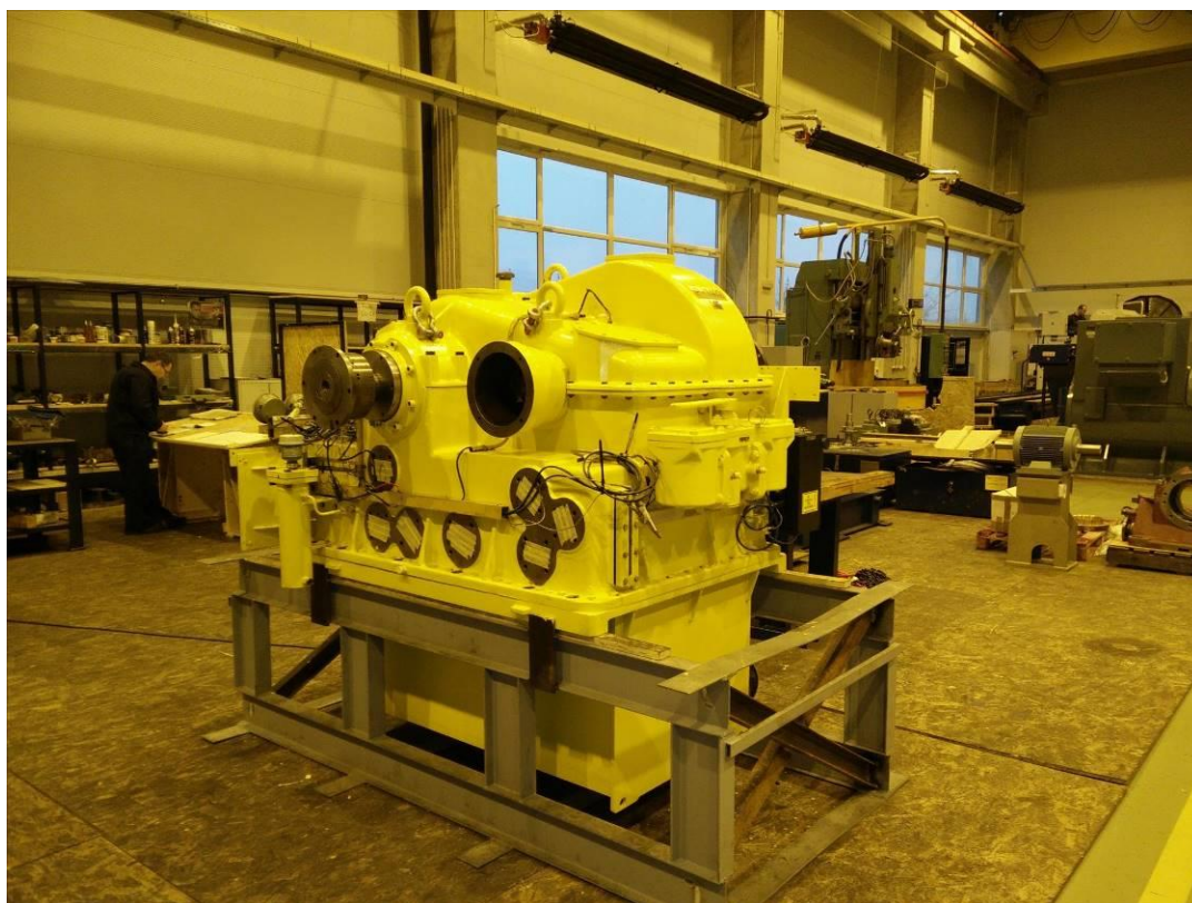
Slika 73. Hidrodinamička spojnica „Voith“
