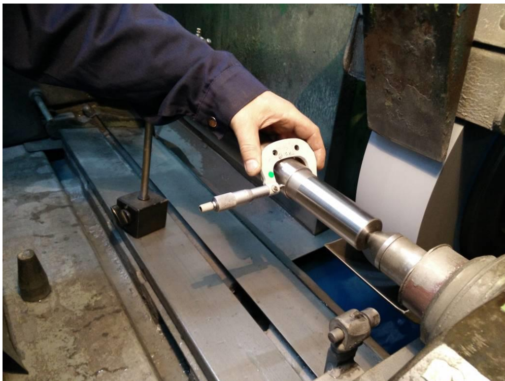
Slika 64. Dimenzionalna kontrola vratila mikrometrom
