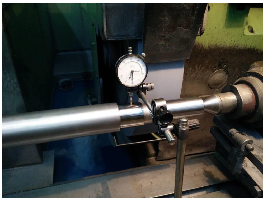
Slika 65. Kontrola radijalnih udara vratila
