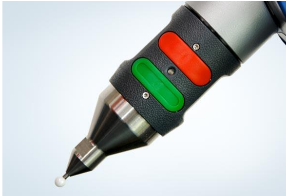
Slika 17. Tipke koje služe za prikupljanje podataka u procesu mjerenja [4]
