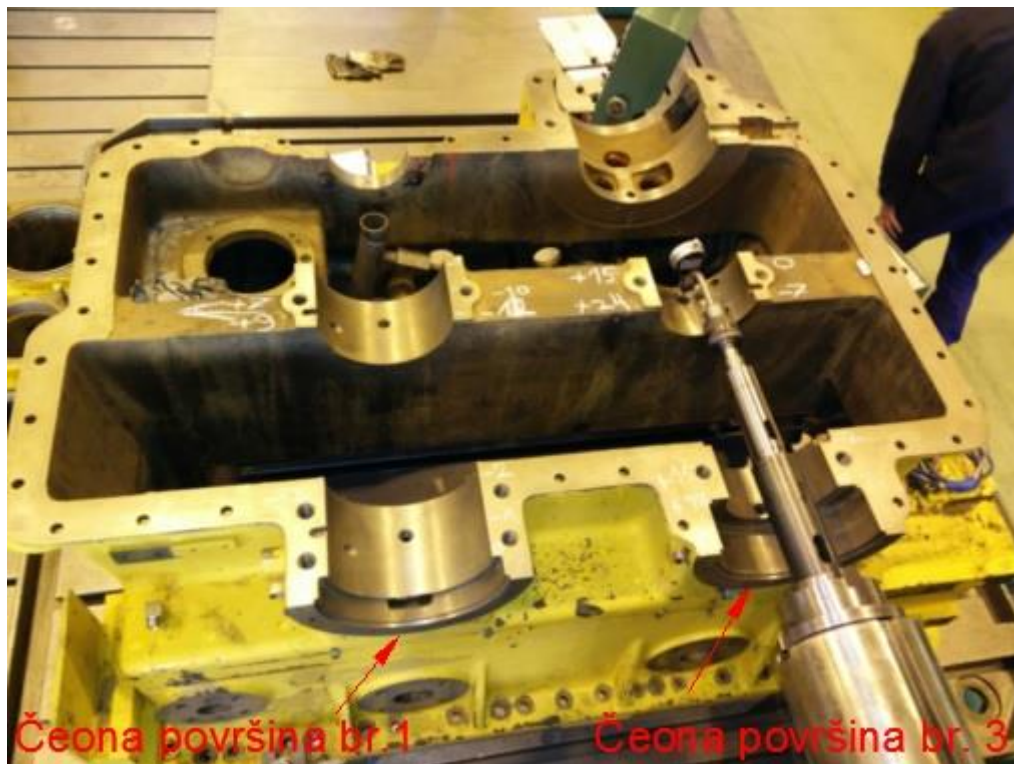
Slika 76. Bazne površine za centriranje
