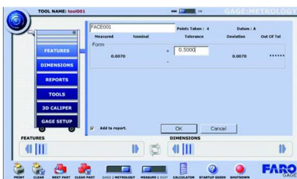
Slika 47. Rezultati mjerenja čeonj površine
