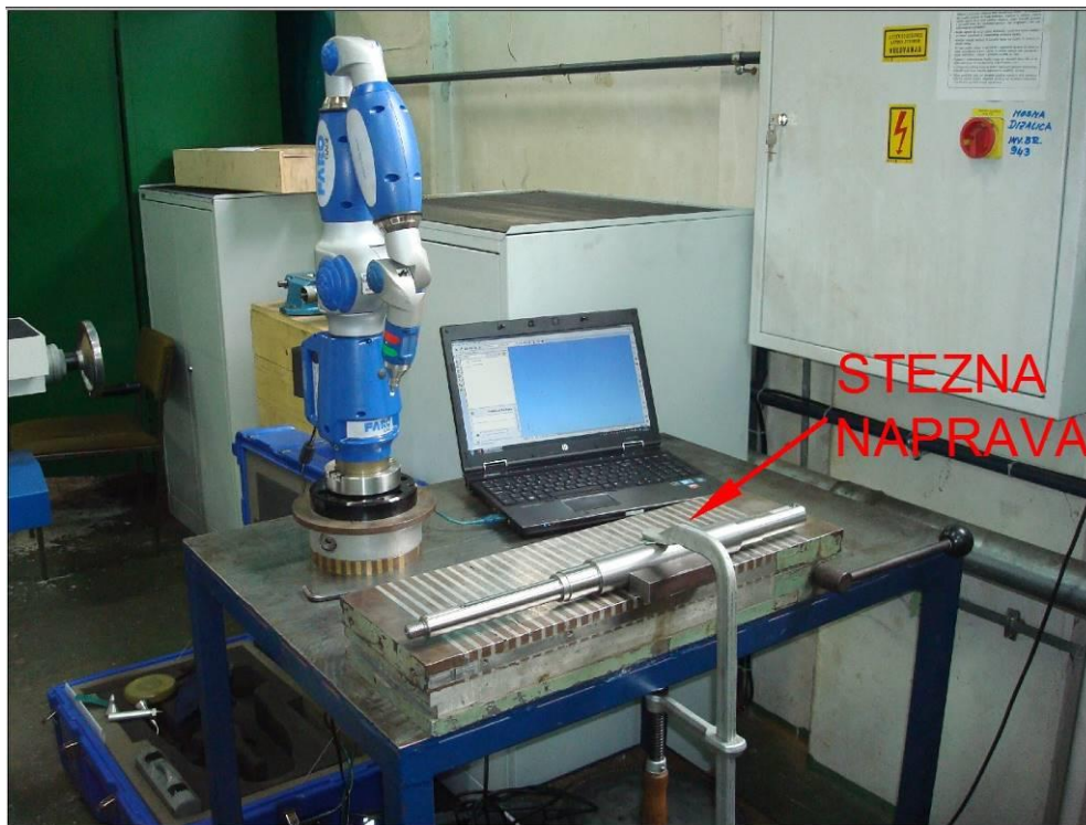
Slika 67. Vratilo spremno za kontrolu
