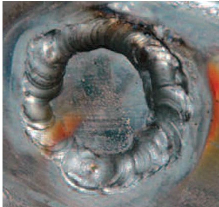
Slika br.13. Primjer ispunjavanja rupe zavarom
