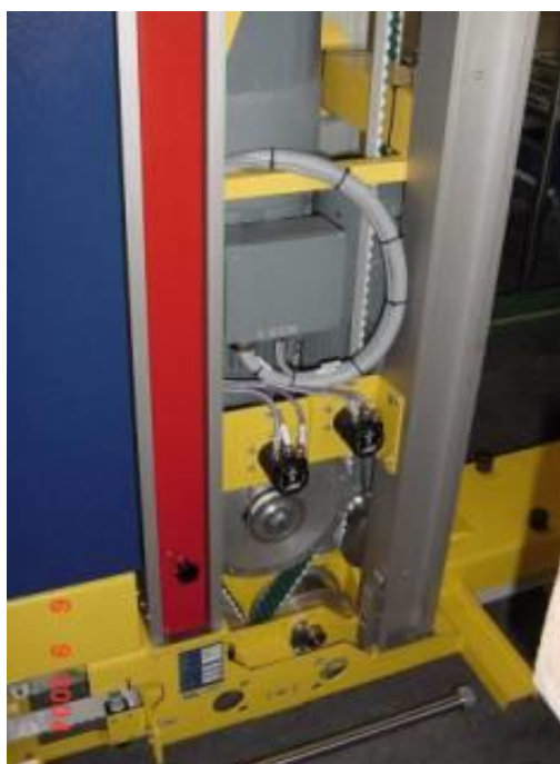
Slika 13. Pogon Miniload dizalice
