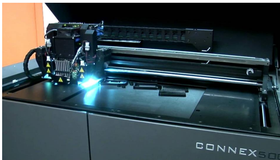
Slika 8. Polyjet pisac CONNEX 500 [8]
