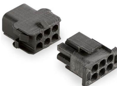
Slika 10. Primjer izrađenih modela FDM postupkom [10]
