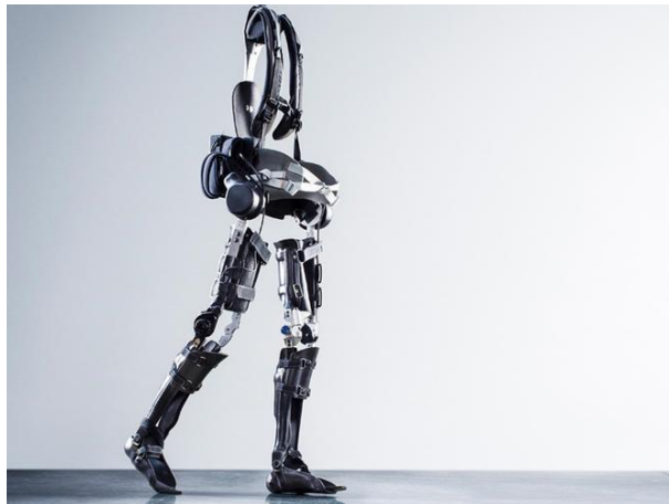
Slika 22. Predodžba Phoenixovog egzoskeleta. Izvor: http://inhabitat.com/
