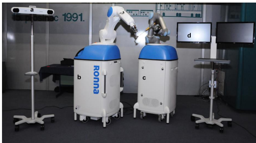
Slika 31. Predodžba RONNA-e (a – RONNAvision modul s komercijalno dostupnim Polaris sustavom; b – glavni robot na pomičnom stalku s integriranom upravljačkom jedinicom i napajanjem; c – pomoćni robot na pomičnom stalku s integriranom upravljačkom jedinicom i napajanjem; d – ekran za nadzor rada sustava). Izvor: https://www.fsb.unizg.hr/
