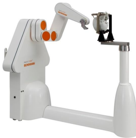
Slika 29. Predodžba Neuromatea. Izvor: http://www.renishaw.com/
