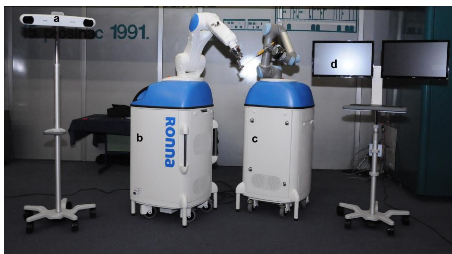
Slika 31. Predodžba RONNA-e (a – RONNAvision modul s komercijalno dostupnim Polaris sustavom; b – glavni robot na pomičnom stalku s integriranom upravljačkom jedinicom i napajanjem; c – pomoćni robot na pomičnom stalku s integriranom upravljačkom jedinicom i napajanjem; d – ekran za nadzor rada sustava). Izvor: https://www.fsb.unizg.hr/
