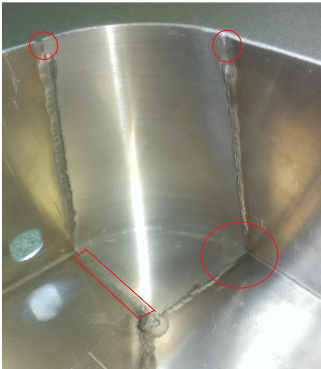
Slika 42. Pozicija zavarena TIG postupkom
