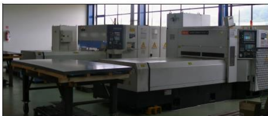
Slika 20. Laseri za izrezivanje pozicija iz lima
