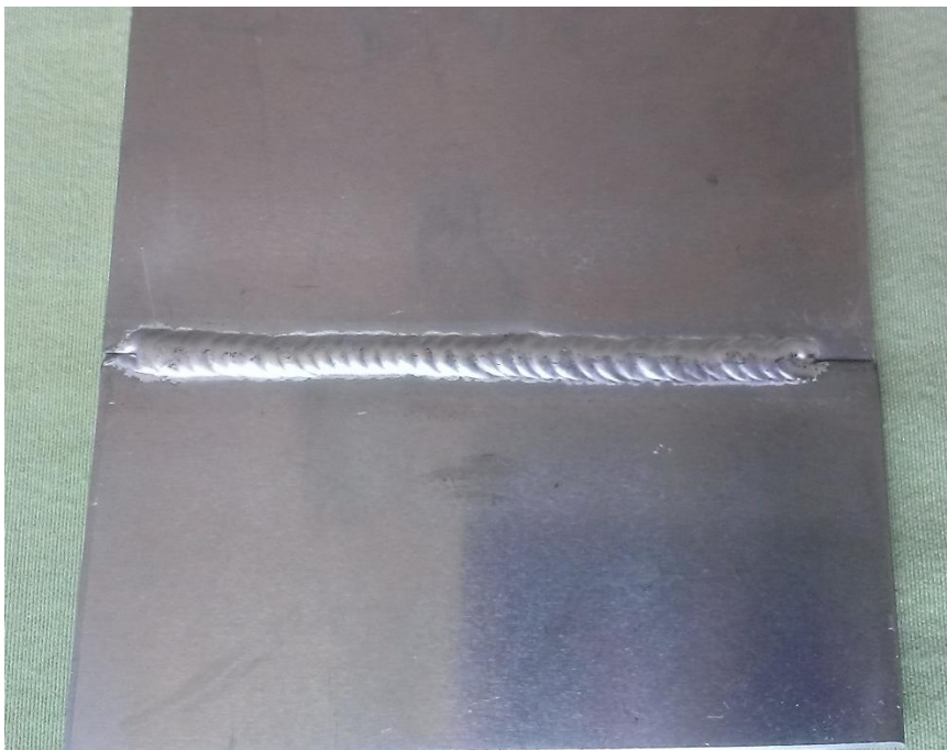
Slika 27. Uzorak zavaren MIG postupkom
