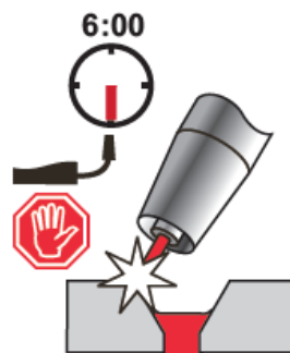
Slika 29. Prekid električnog luka, završetak zavarivanja na poziciji 6 sati [15]
