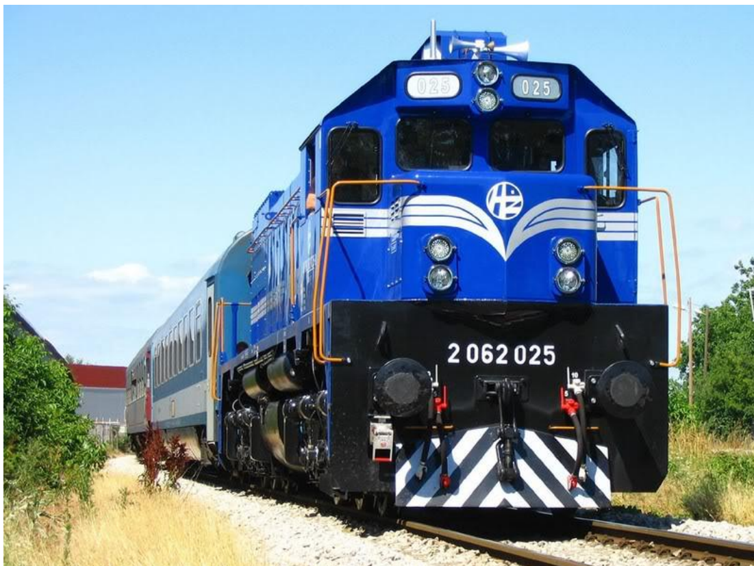
Slika 23. Hibridna lokomotiva „Ličanka“, u vlasništvu Hrvatskih željeznica
