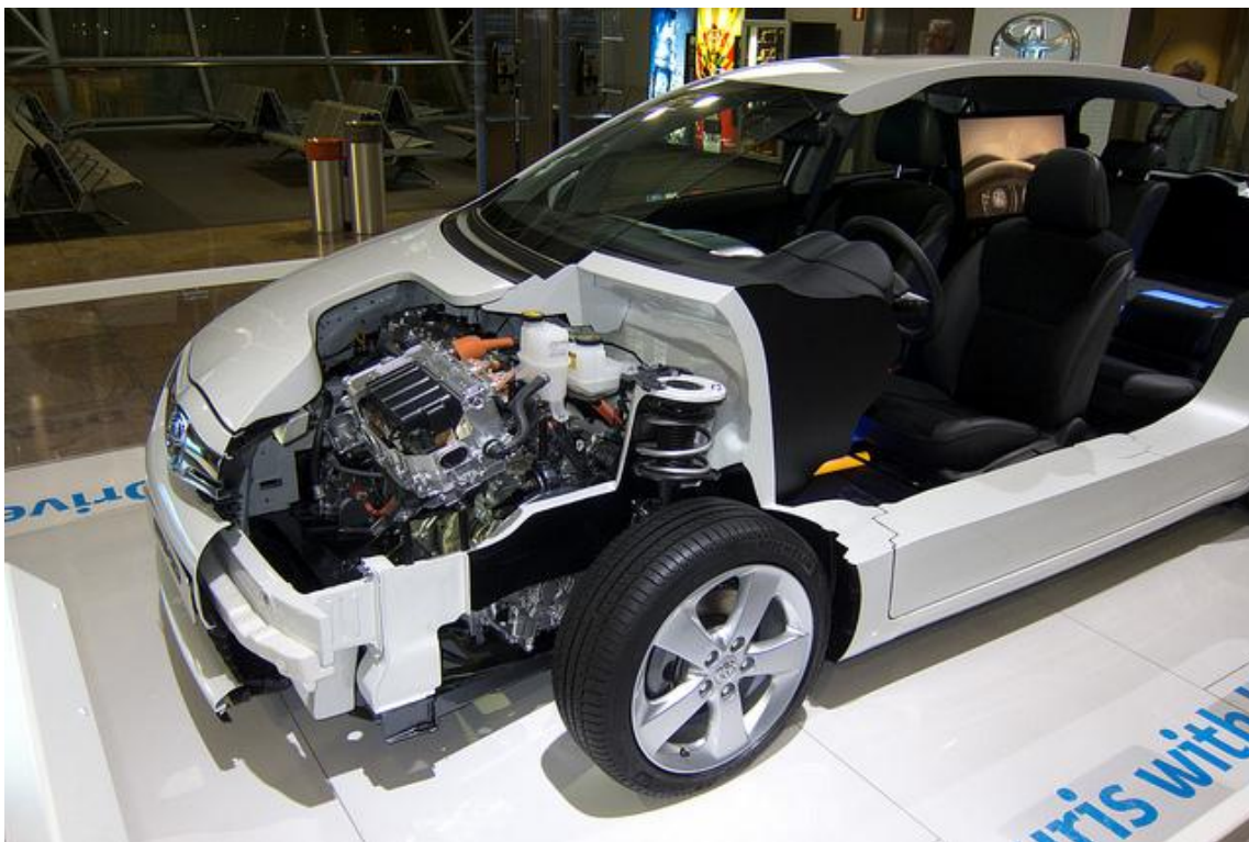
Slika 4. Presjek hibridnog automobila marke Toyota
