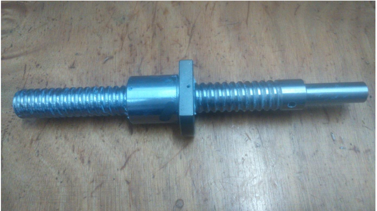
Slika 23: Novo kuglično navojno vreteno s kugličnom maticom
