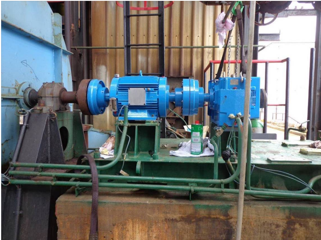
Fotografija 6.1 Montaža reduktora i uključno-isključne spojke
