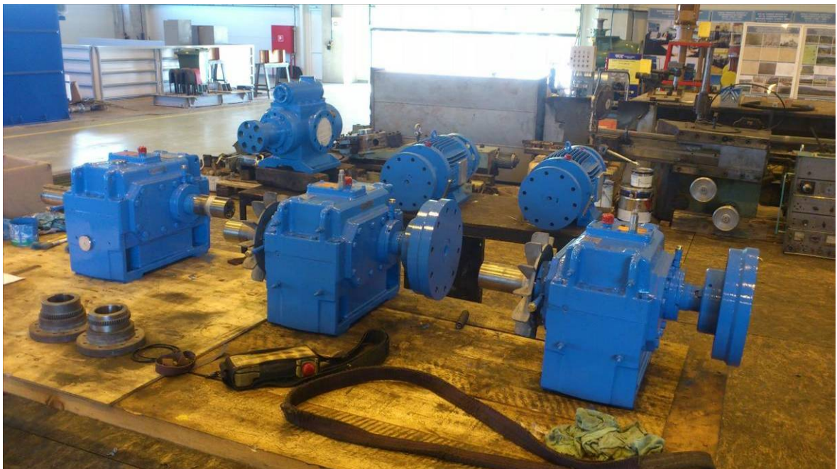
Fotografija 4.4 Podmontaža reduktora i uključno-isključne spojke
