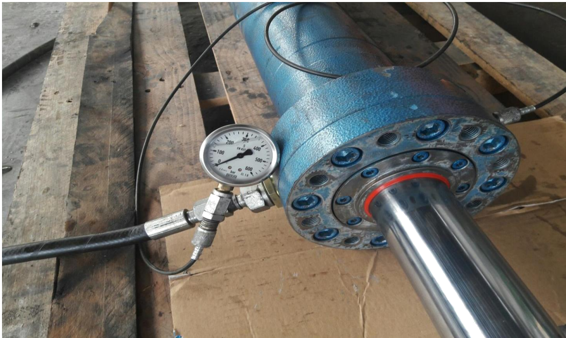
Slika 36. Ispitivanje hidrauličnog cilindra na tlak i ne propusnost
