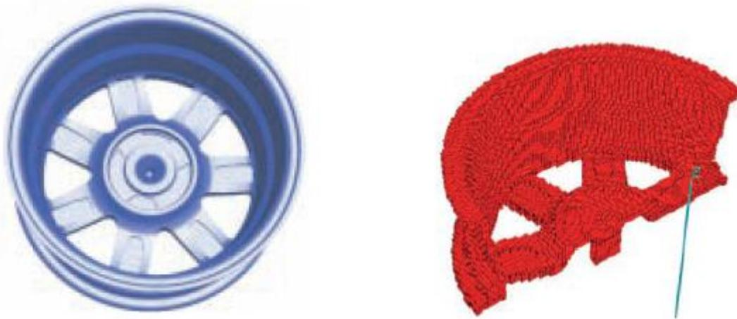
Slika 46. Prikaz 3D modela (lijevo) te prikaz aluminijskog odljevka u mreži (desno).
