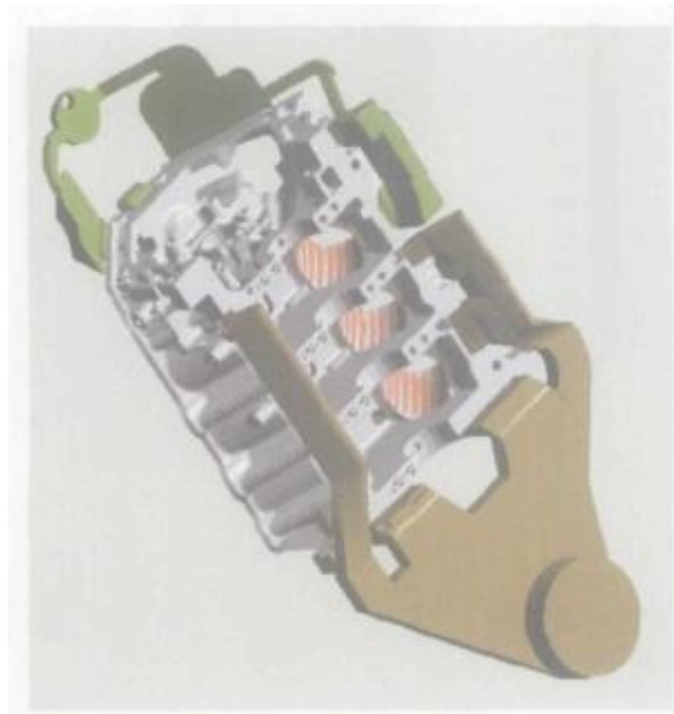
Slika 24. Prikaz novog modela bloka motora sa „J-Runner“ sistemom punjenja kalupa
