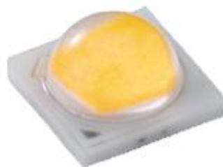
Slika 22 LED dioda Nichia NVSL219BT-V1 [14]
