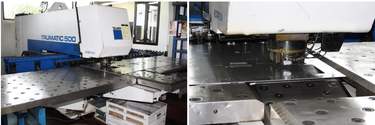
Slika 28 Izrezivanje lima za kućište i probijanje rupa
