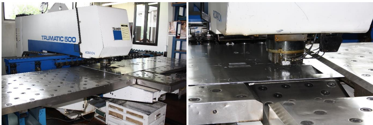
Slika 28 Izrezivanje lima za kućište i probijanje rupa
