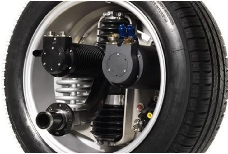
Slika 8. Sustav regenerativnog kočenja unutar kotača automobila
