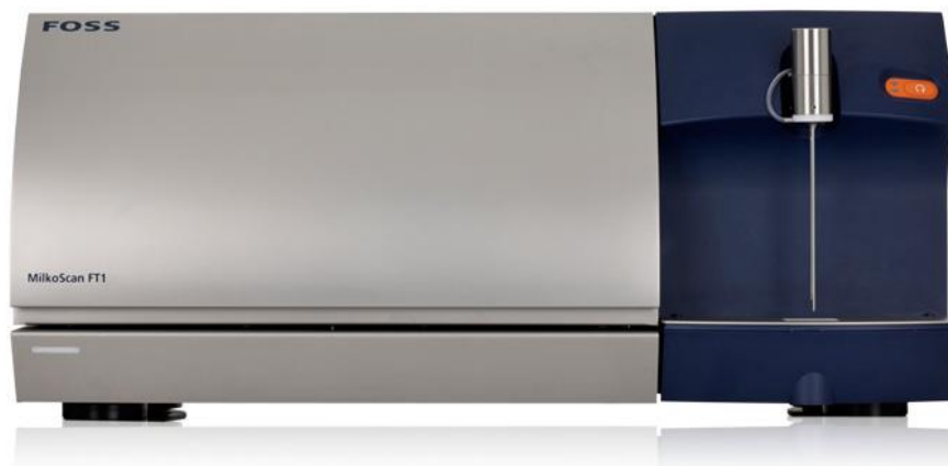
Slika 6. Spektroskopski uređaj za analizu mlijeka i sladoledne smjese MilkoScan FT1 (FOSS , 2016)
