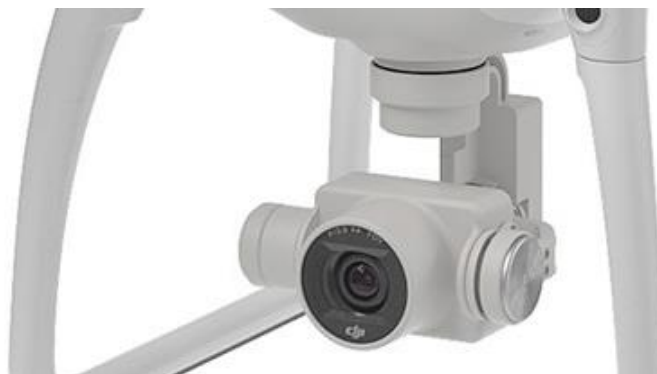
Sl. 25. Kamera i stabilizator kamere [33]
