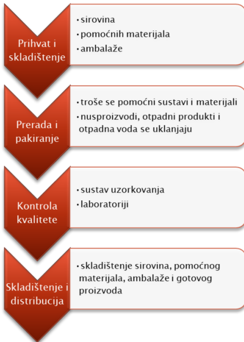
Slika 6. Funkcija različitih dijelova pogona u preradi hrane.
