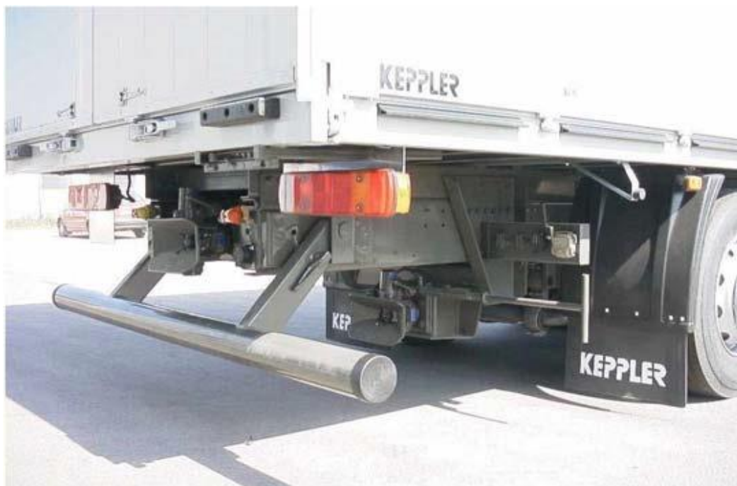
Slika 10. Uređaj za spajanje prikolica [3]
