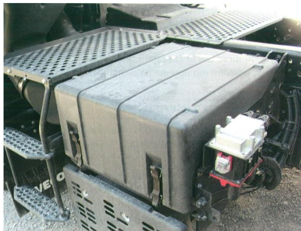
Slika 7. Akumulator motornog vozila [3]
