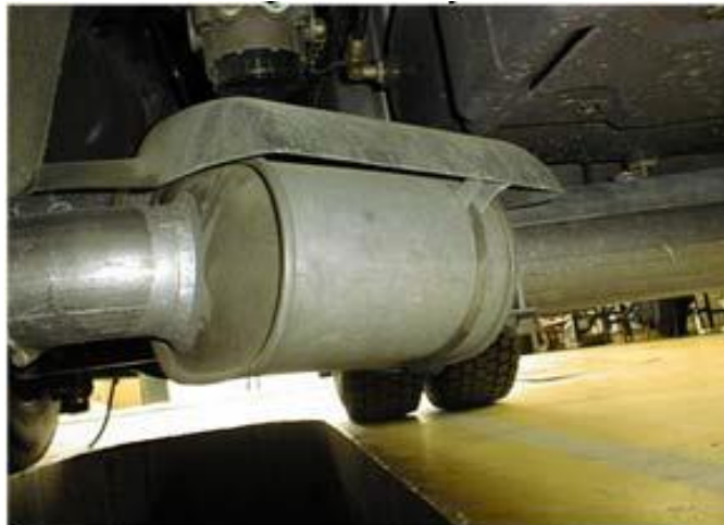
Slika 8. Zaštićeni dijelovi ispušnog sustava [3]
