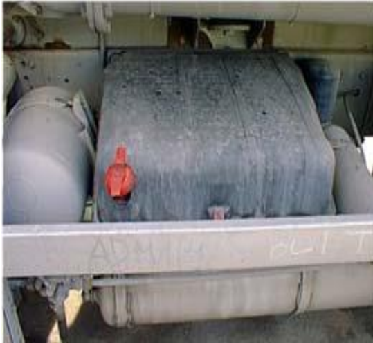
Slika 5. Sklopka za prekid strujnih krugova [3] Slika 6. Indikator o uključenosti sklopke [3]
