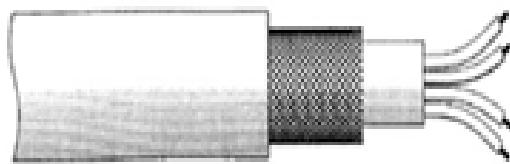
Slika 4. Električni provodnik kod motornih vozila [3]
