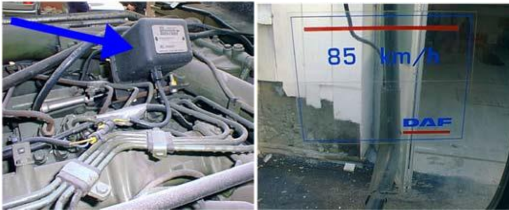
Slika 9. Uređaj za ograničavanje brzine motornog vozila [3]
