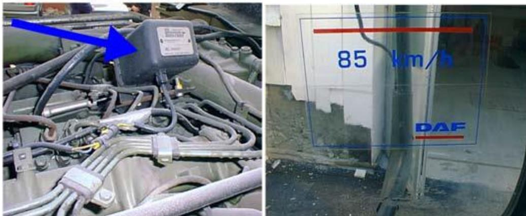
Slika 9. Uređaj za ograničavanje brzine motornog vozila [3]
