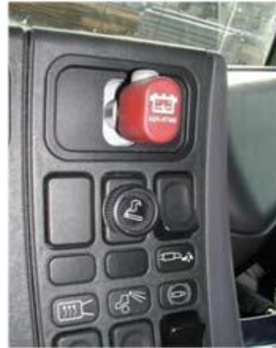
Slika 5. Sklopka za prekid strujnih krugova [3] Slika 6. Indikator o uključenosti sklopke [3]
