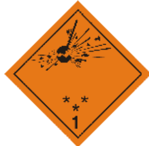
Slika 15. Ploče za dopunsko označavanje vozila pri prijevozu sredstava skupine 1.1, 1.2 ili 1.3. [3]
