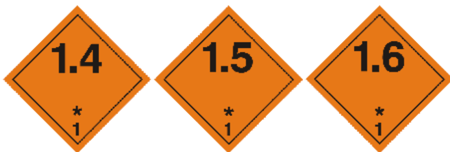
Slika 16. Ploče za dopunsko označavanje vozila pri prijevozu sredstava skupine 1.4, 1.5 ili 1.6. [3]
