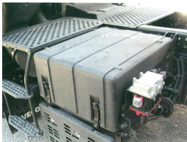
Slika 7. Akumulator motornog vozila [3]
