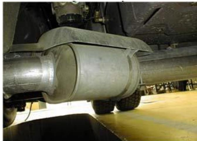
Slika 8. Zaštićeni dijelovi ispušnog sustava [3]
