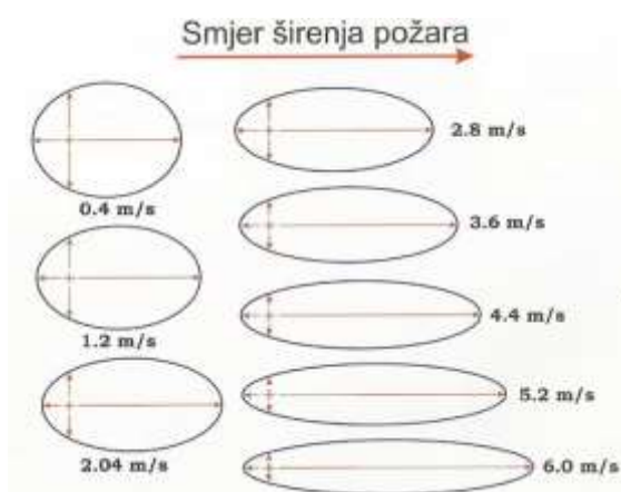
Sl. 2. Elipsasti oblik požara po utjecajem vjetra [4]
