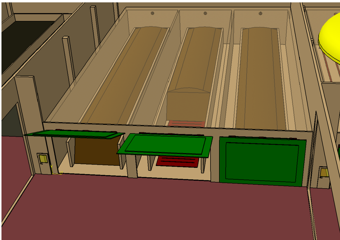
Slika 48. Tuneli za biosušenje digestata.
