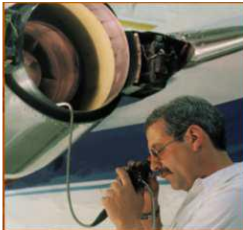
Slika 7. Moderna vizualna kontrola fiberoskopom [3]
