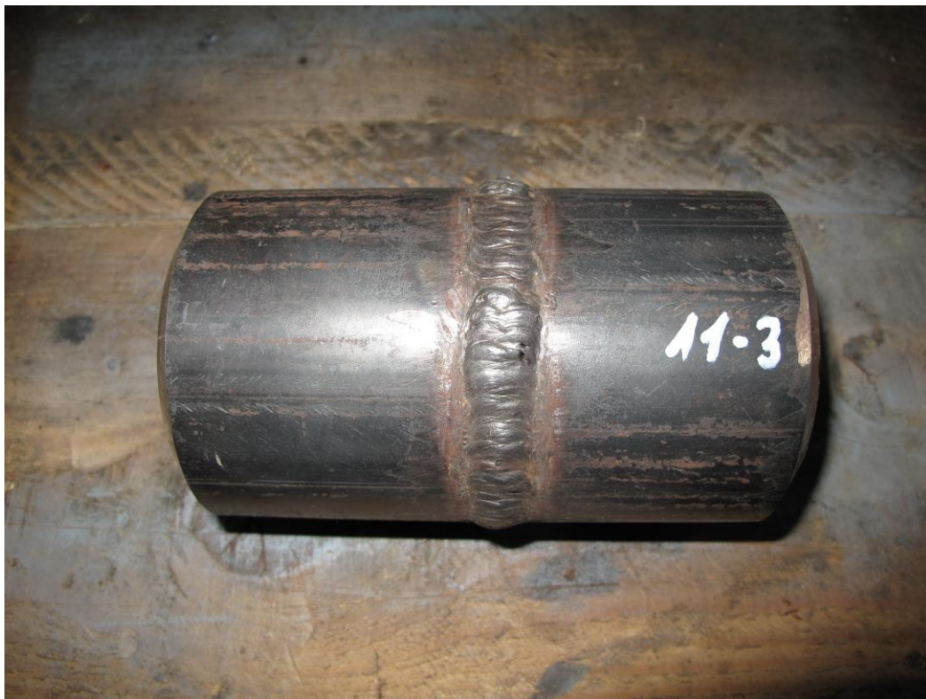
Slika 30. Čista površina pripremljena za nanošenje penetranta
