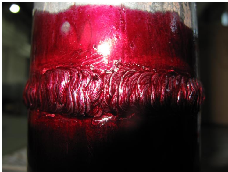
Slika 32. Uvećani prikaz nanešenog penetranta na površinu zavora
