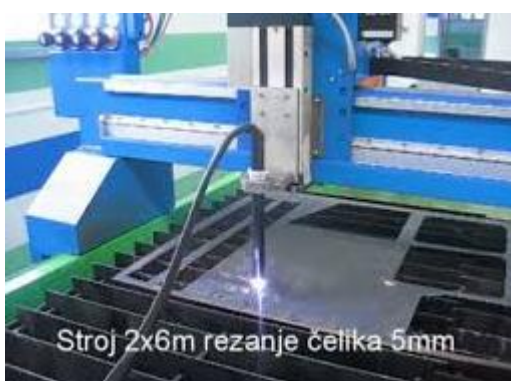
sl.53. Strojno rezanje plazmom
