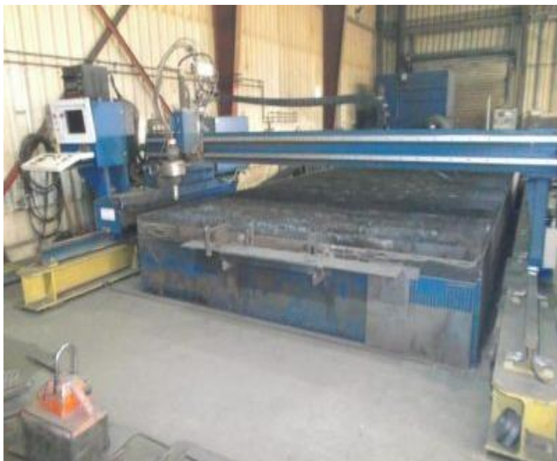
sl. 41. – CNC portalna rezalica – Messer Cortina
