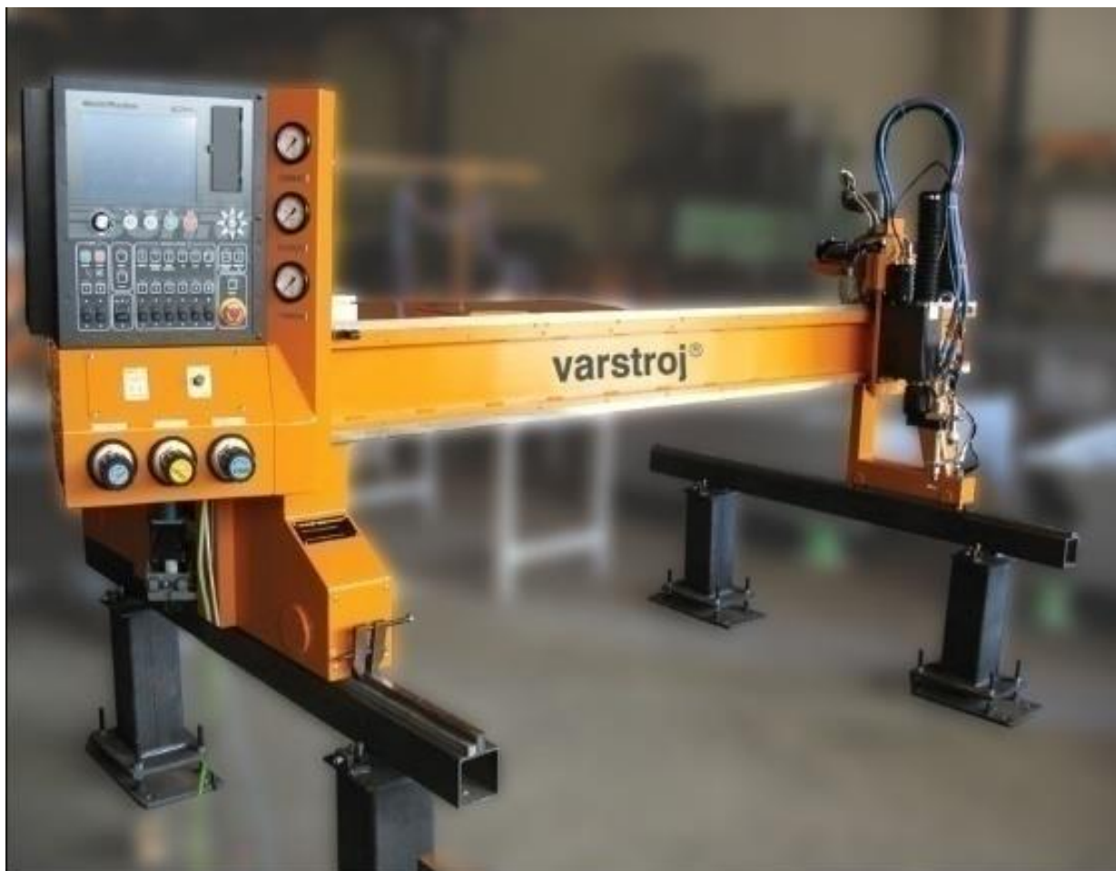
Slika 34 : CNC rezanje plazmom - Varstroj ( Lendava, SLO)
