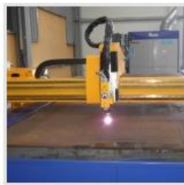
sl. 15. CNC rezanje plazmom
