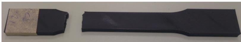
Slika 3.21. Model epruvete od PLA polimera sa dodatkom željeza sa magnetičnim svojstvima
