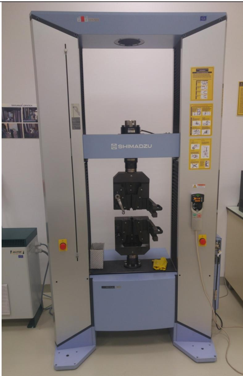
Slika 3.15. Kidalica na kojoj je odrađeno ispitivanje materijala
