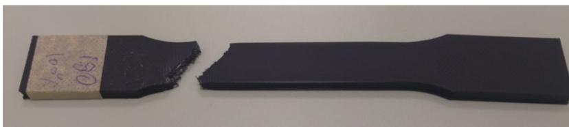
**Slika 3.19. Model epruvete izrađen od običnog PLA polimera**
