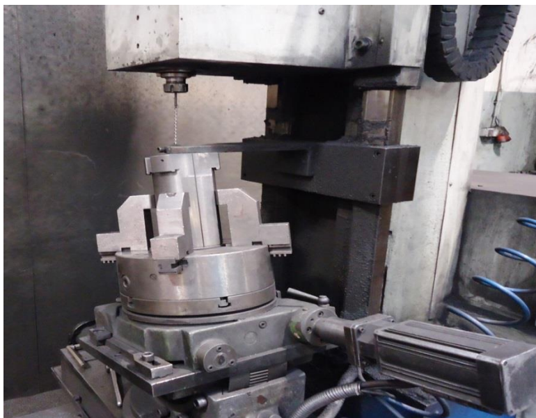
Slika 38. Bušenje vakuum rupa
