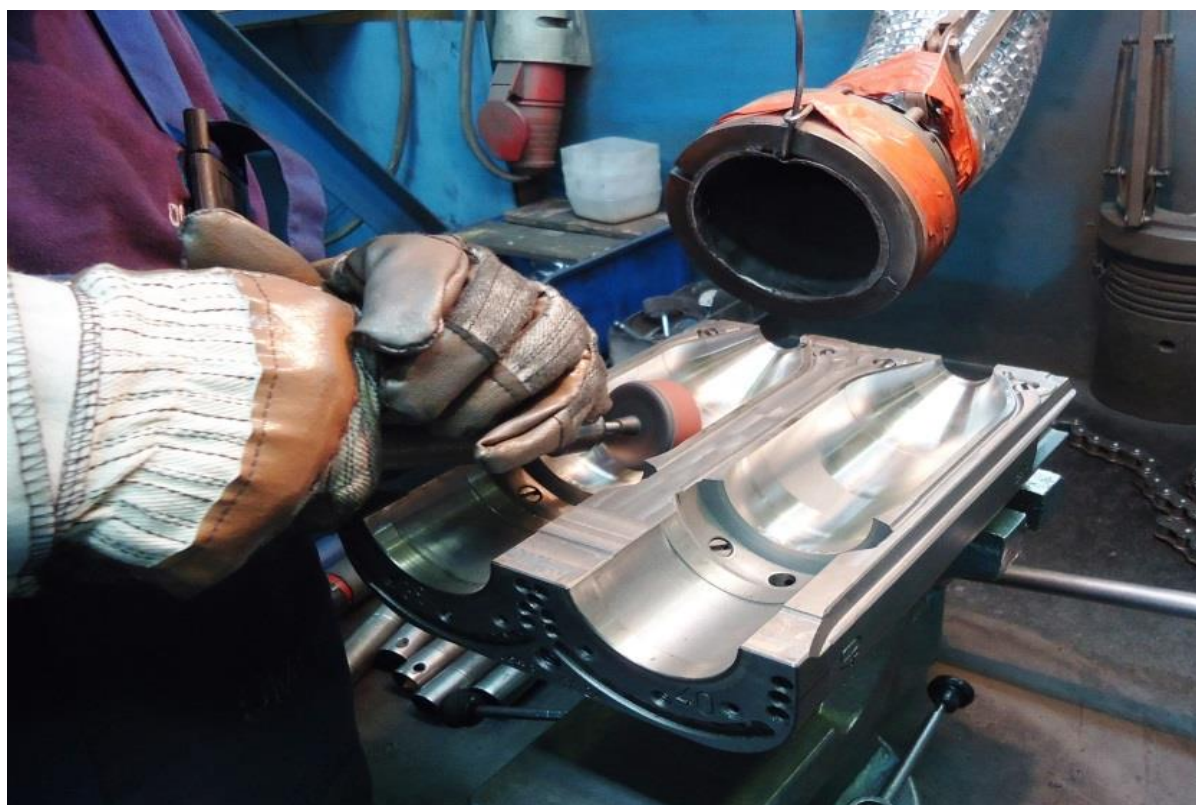
Slika 95. Prikaz poliranja kalpa
