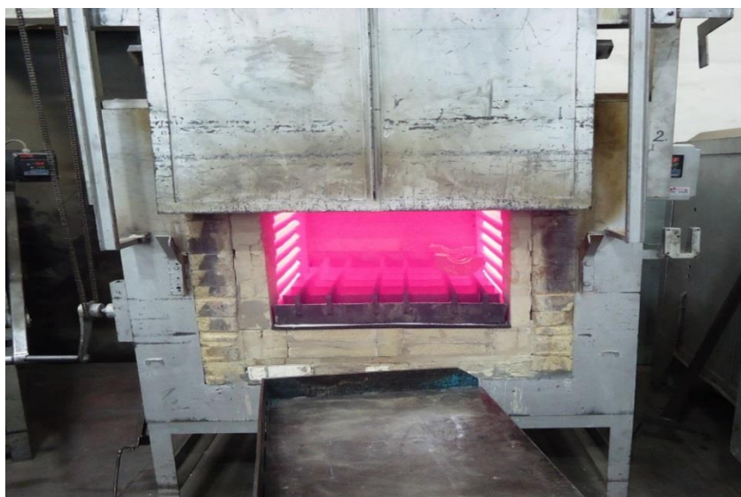
Slika 25. Predgrijavanje u komornoj peći
