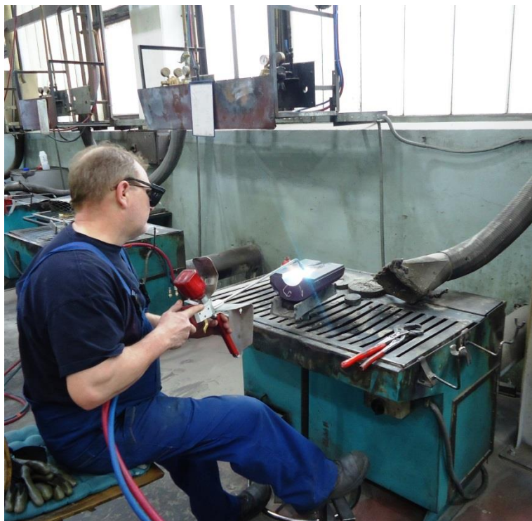
Slika 26. Ručno navarivanje kalupa
