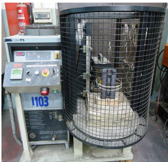
Slika 29. Predgrijavanje elektro peć
