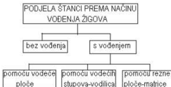
Slika 17. Podjela štanci prema načinu voženja žiga
