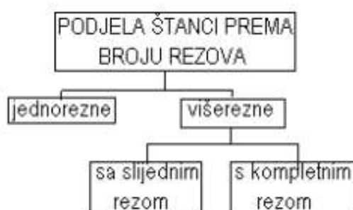
Slika 16. Podjela štanci prema broju rezova
