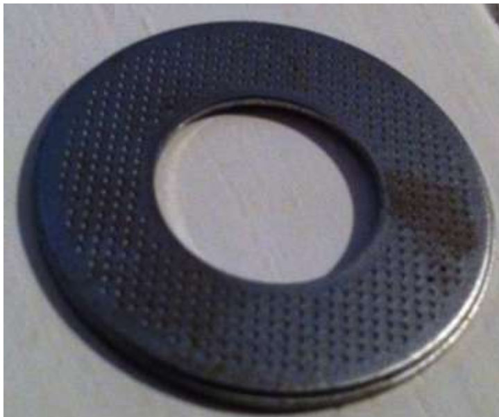
Slika 105. Otisnuća na pločici brojila
