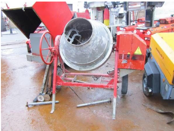
Slika 13 Prikaz betonske mješalice [ https://autoline.hr/img/s/gradevinska-oprema-betonska-mjesalicaMANITOU-BF-BSI-340-S---1_big--13120515321757706200.jpg ]
