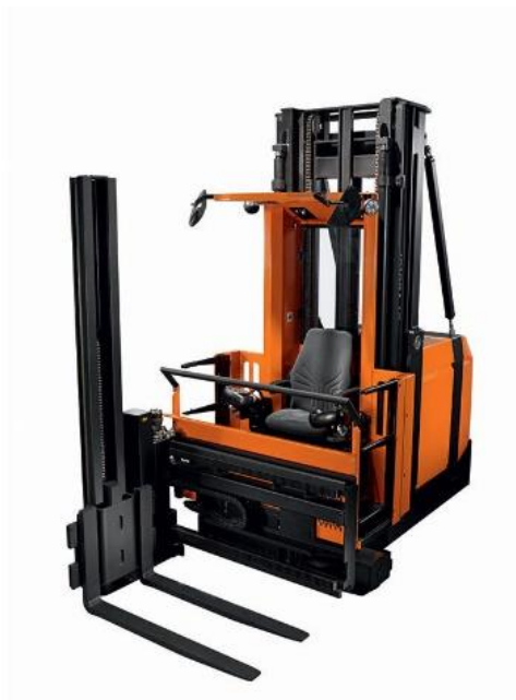
Slika 4. Električni visokoregalni viličar BT Vector A
