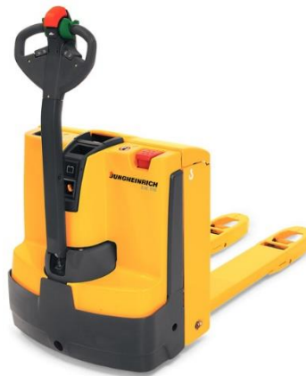
Slika 1. Ručno vođeni elektroviličar za nisko podizanje
