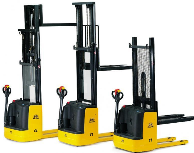
Slika 2. Ručno vođeni elektoviličari za visoko podizanje
