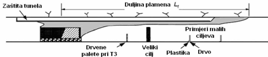
Slika 16 - Razmještaj goriva i ciljnih objekata u testu prijenosa požara u tunelu. [6]
