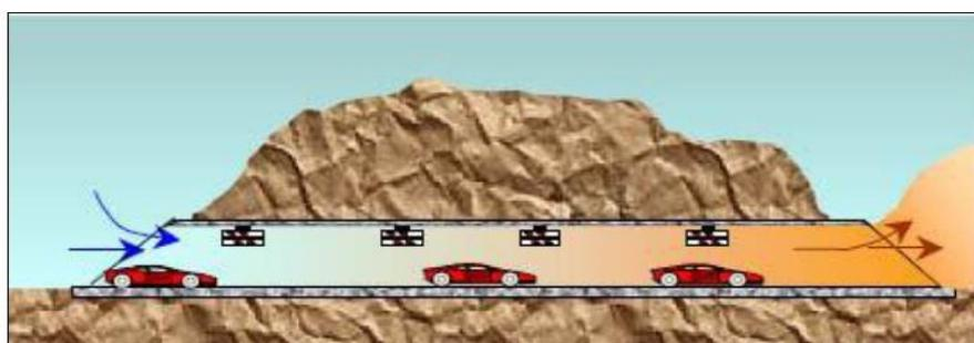
Slika 12 – Uzdužno provjetravanje tunela s ventilatorima na stropu [5]
