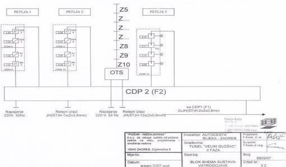
Shematski prikaz 4 - Blok shema vatrodojave tunela Veliki Gložac – CDP2 [3]
