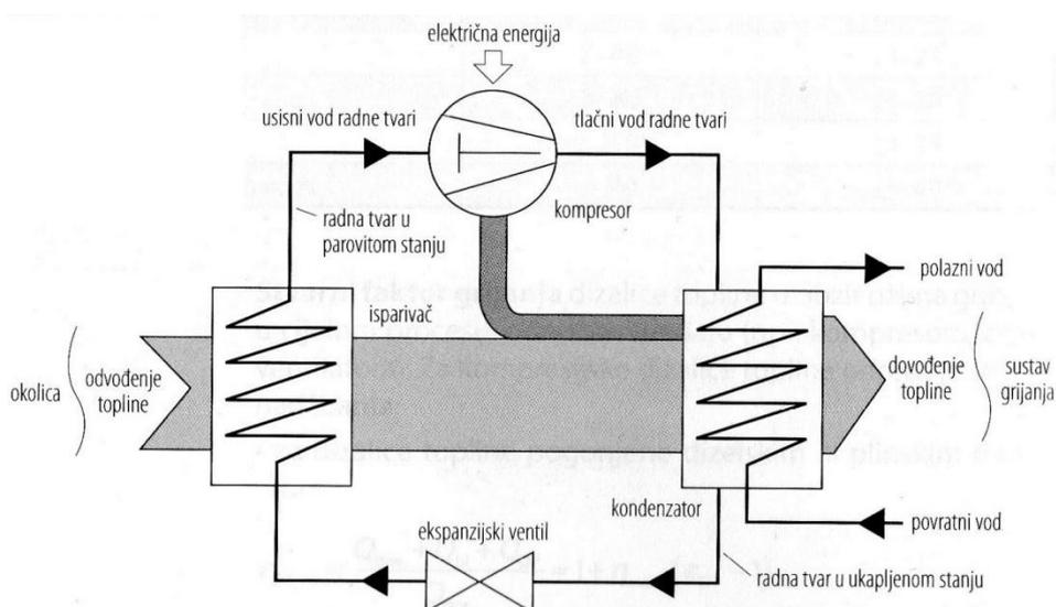
Slika 4. Pojednostavljeni prikaz rada kompresijske dizalice topline, [1].
