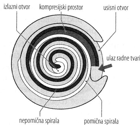
Slika 14. Pojednostavljen prikaz rada spiralnog kompresora, [1].
