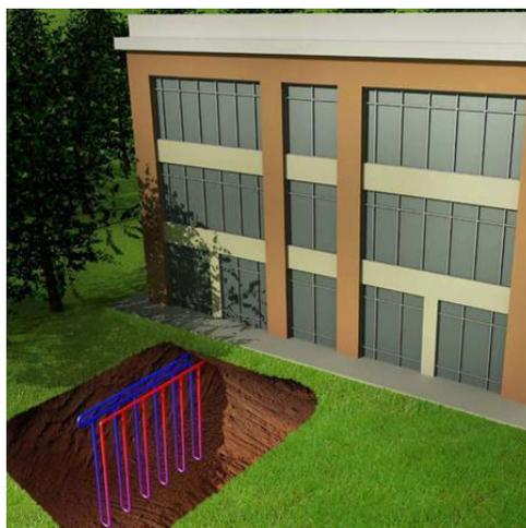
Slika 33. Vertikalni izmjenivači topline u geotermalnoj dizalici topline.
