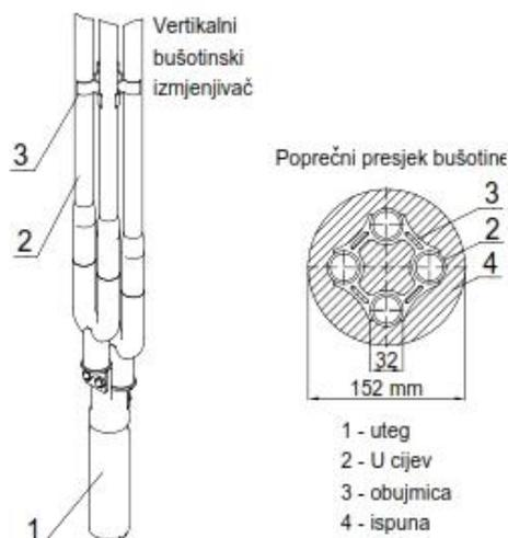
Slika 28. Dvostruka U cijev s utegom i poprečni presjek bušotine s izmjenjivačem topline i ispunom, [1].
