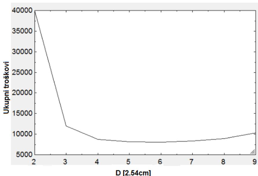
Slika 37. Troškovi cijevi u ovisnosti o promjeru cijevi.
