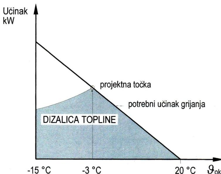
Slika 30. Bivalentno - usporedni način rada, [4].
