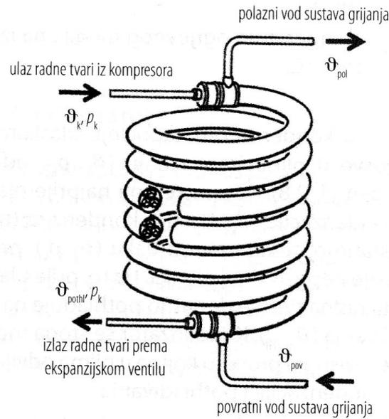
Slika 15. Pojednostavljena shema kondenzatora s dvostrukom koaksijalnom cijevi, [1].
