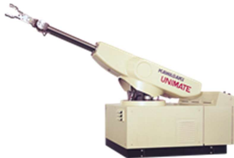
Slika 2. Prvi industrijski robot Unimate
