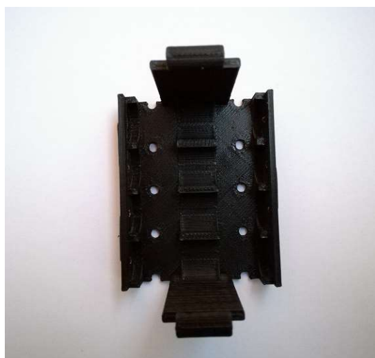
Slika 22. Gotovi dijelovi isprintani ABS materijalom
