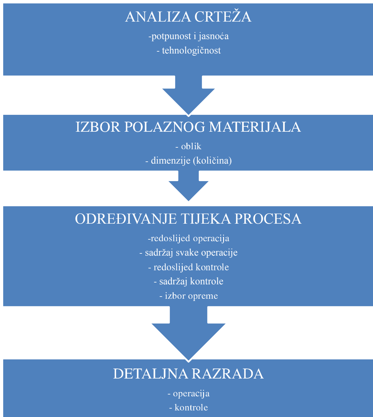
Slika 6.: Opći dijagram tijeka projektiranja tehnološkog procesa
