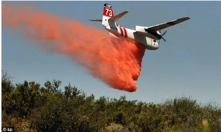
Slika 2. Nanošenje retardanta na vegetaciju iz zraka
