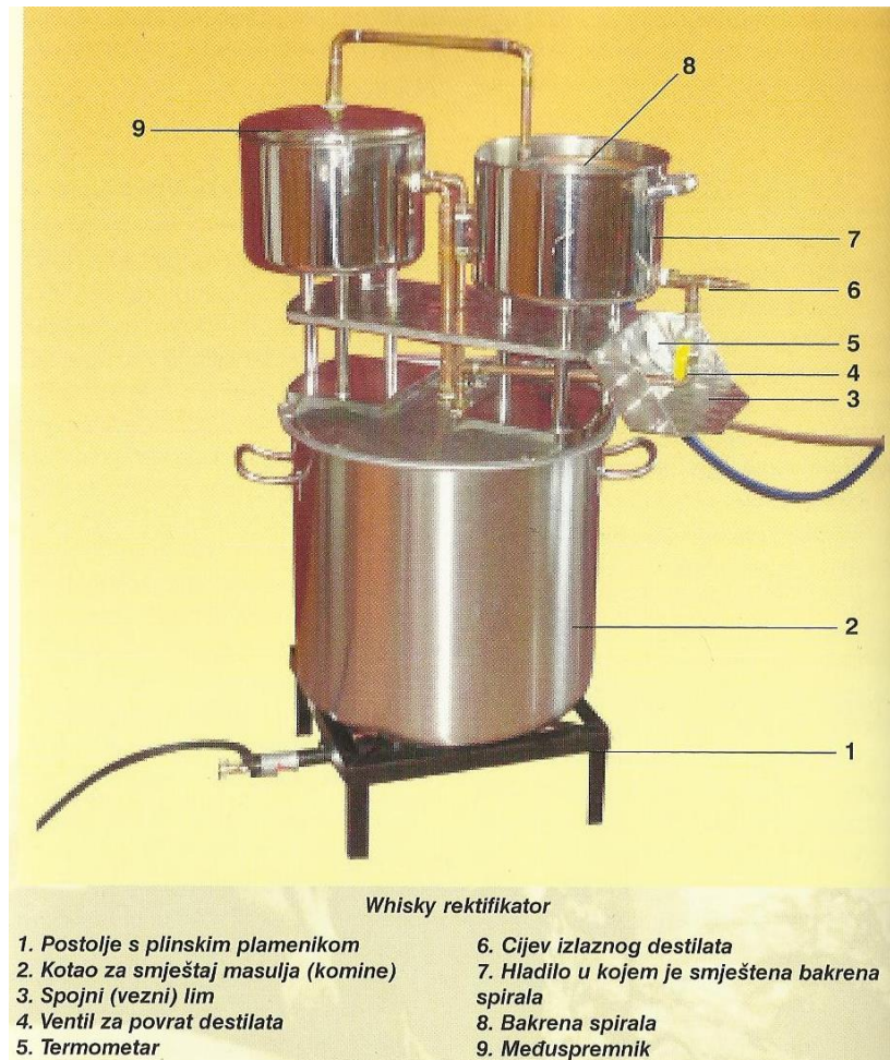
Slika 3. Whisky rektifikator
