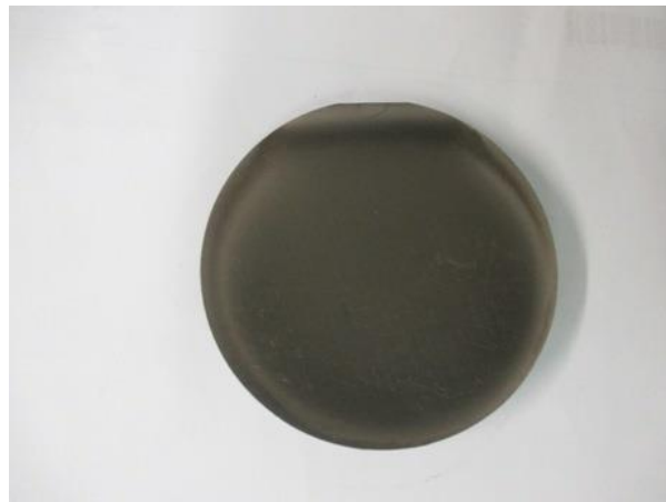
Slika 16. Izgled uzorka nakon nitriranja
