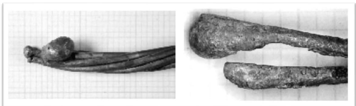
Slika 9: Prikaz kuglica nastalih kao posljedica požara [12].
