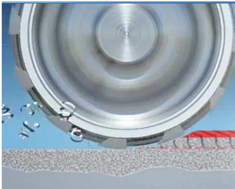
Slika 21. Obrada gornje površine tračnica klasičnim brušenjem [15]
