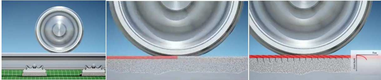
Slika 20. Pojava mikropukotina na željezničkim tračnicama [15]
