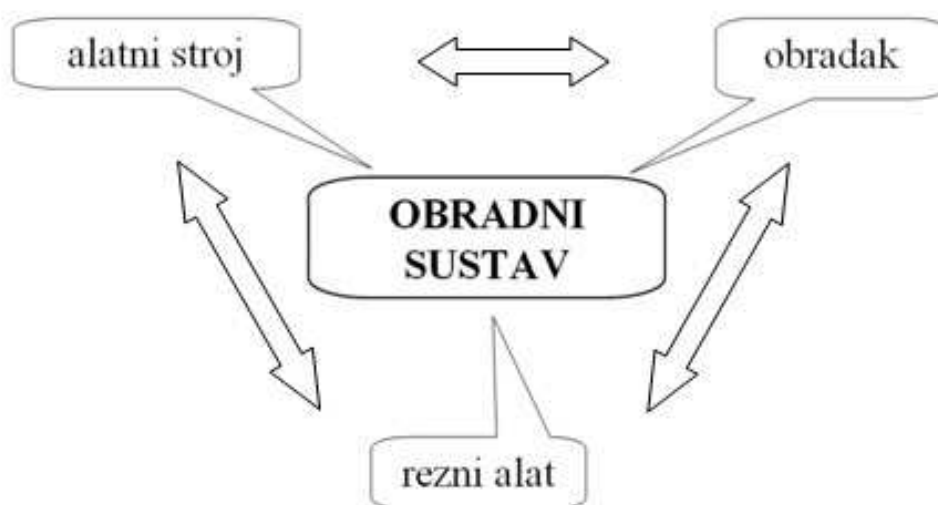
Slika 1. Osnovni elementi obradnog sustava [2]
