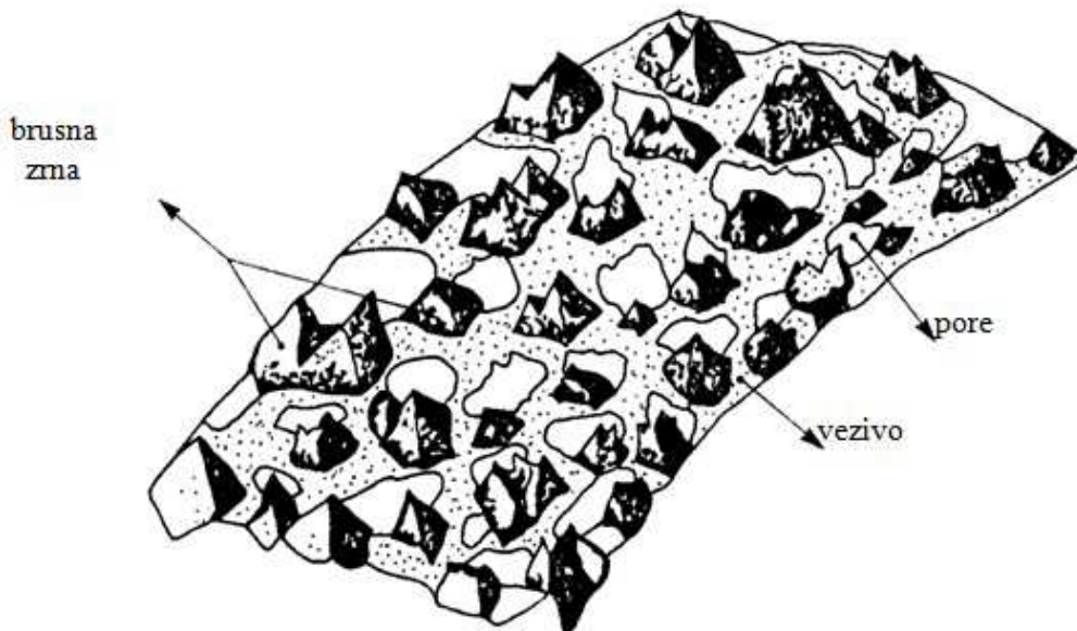
Slika 3. Rezna površina brusna [4]
