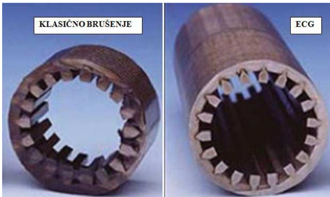
Slika 25. Obradak obrađen klasičnim brušenjem i ECG-om [19]
