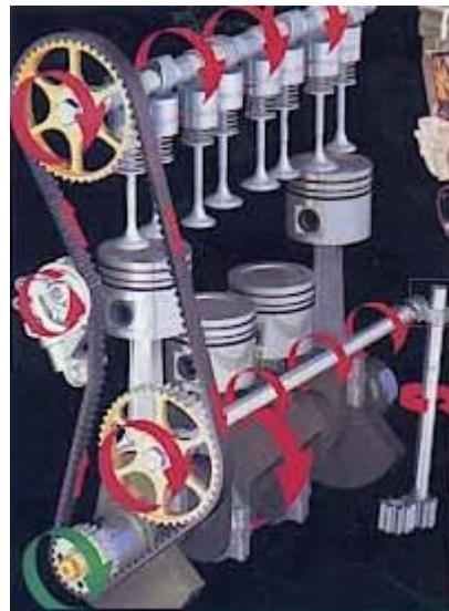
Slika 6 Razvodni mehanizam
