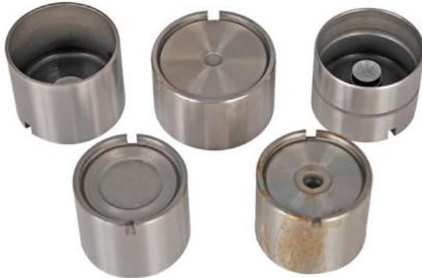
Slika 17 Hidraulički podizač ventila
