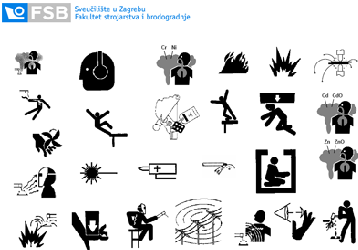
Slika 4. Mjere opreza kod ručnog zavarivanja
