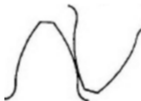
Slika 9. Zahvat evolventnih bokova
