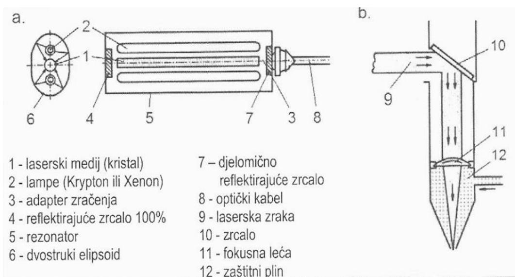
Slika 24. Princip rada lasera s čvrstim medijem Nd:YAG [9]
