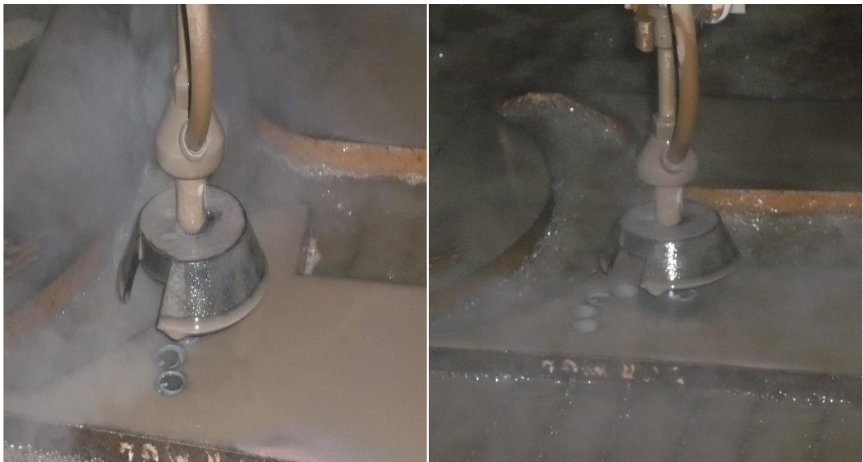
Slika 43. Rezanje provrta promjera 14 mm
