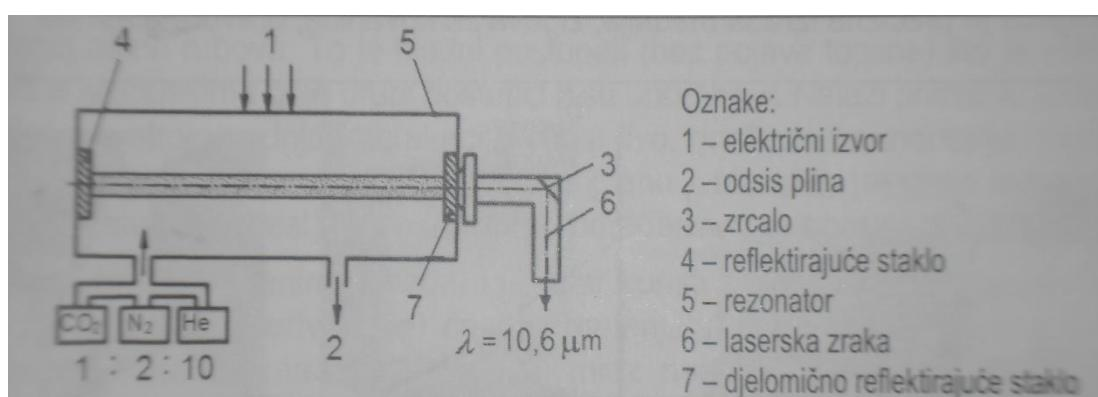
Slika 21. Shema i princip rada CO<sub>2</sub> lasera [9]
