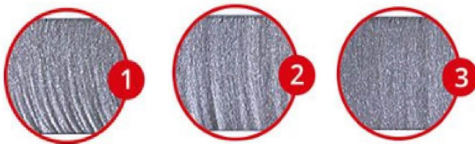
Slika 18. Utjecaj brzine obrade na izbrazdanost površine reza
