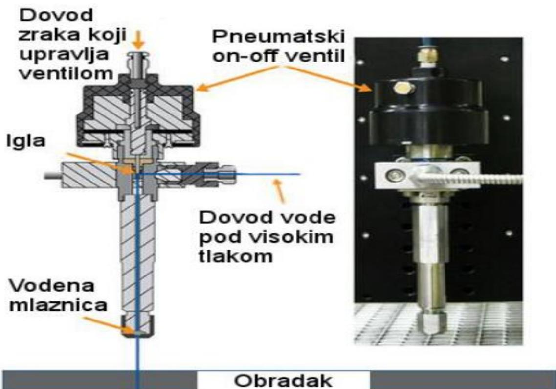
Slika 1. Rezna glava za obradu čistim vodenim mlazom
