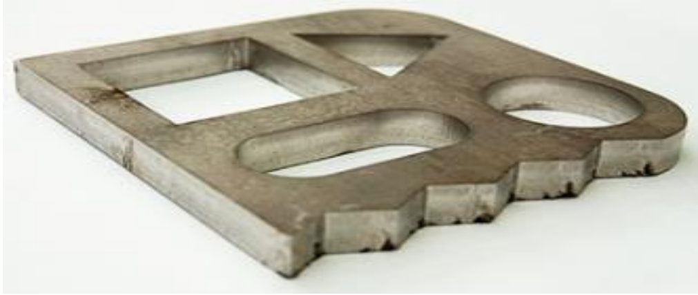
Slika 34. Element izrezan laserom
