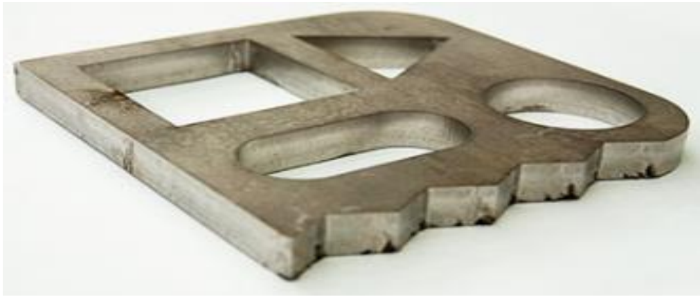
Slika 34. Element izrezan laserom
