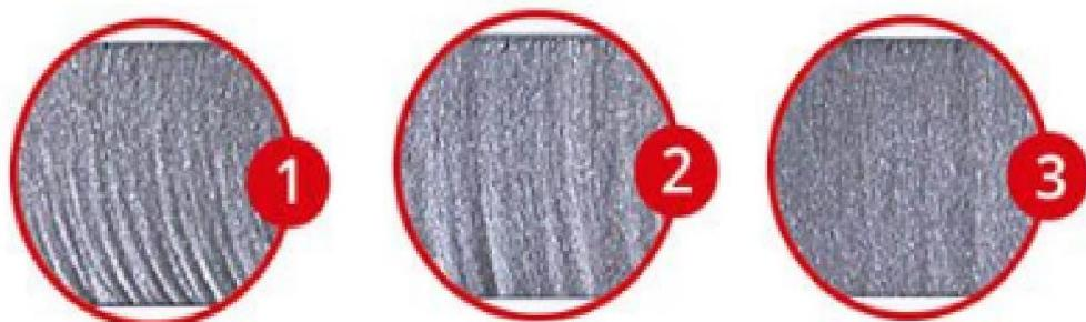
Slika 18. Utjecaj brzine obrade na izbrazdanost površine reza
