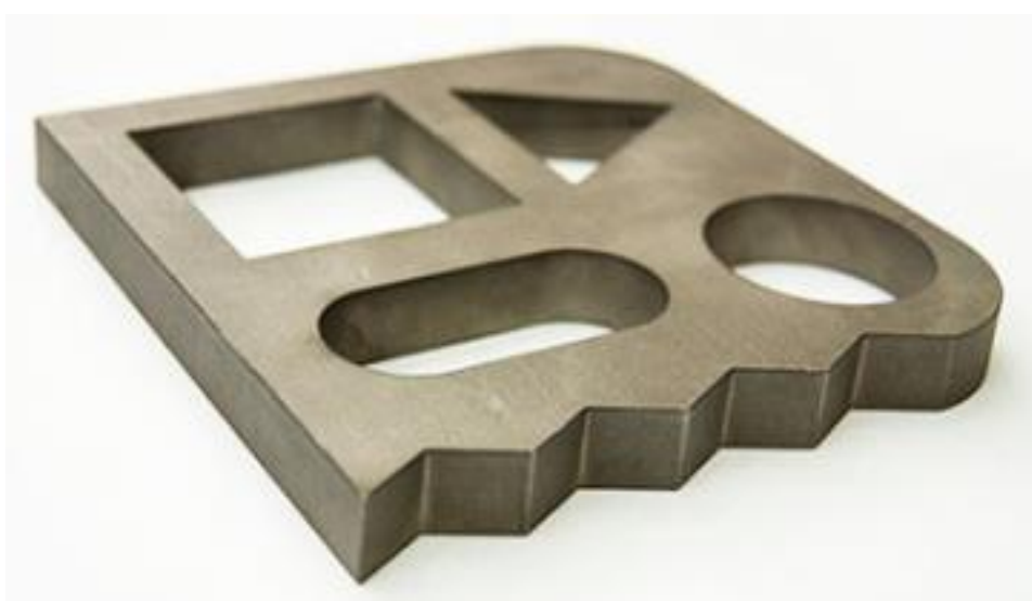
Slika 33. Element izrezan abrazivnim vodenim mlazom
