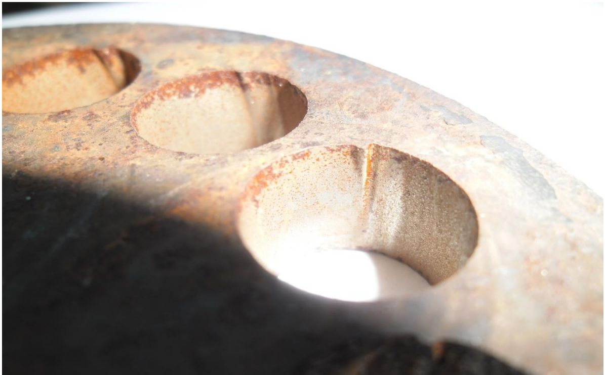
Slika 45. Pogreška nastala pri obradi promjera promjera 14 mm
