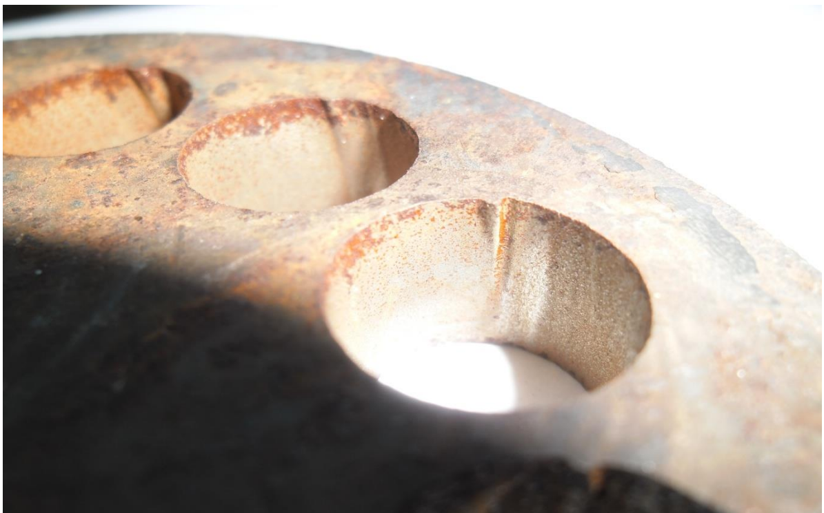
Slika 45. Pogreška nastala pri obradi promjera promjera 14 mm
