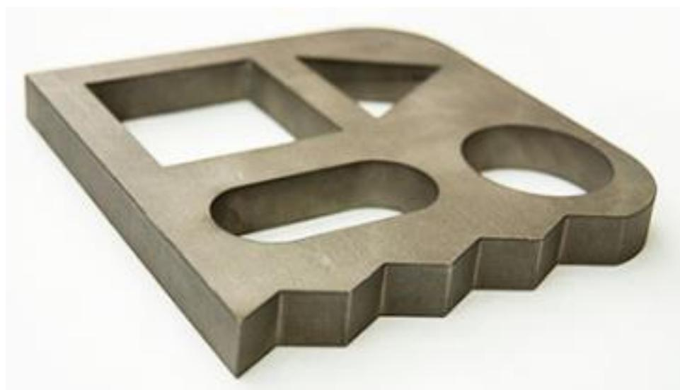
Slika 33. Element izrezan abrazivnim vodenim mlazom
