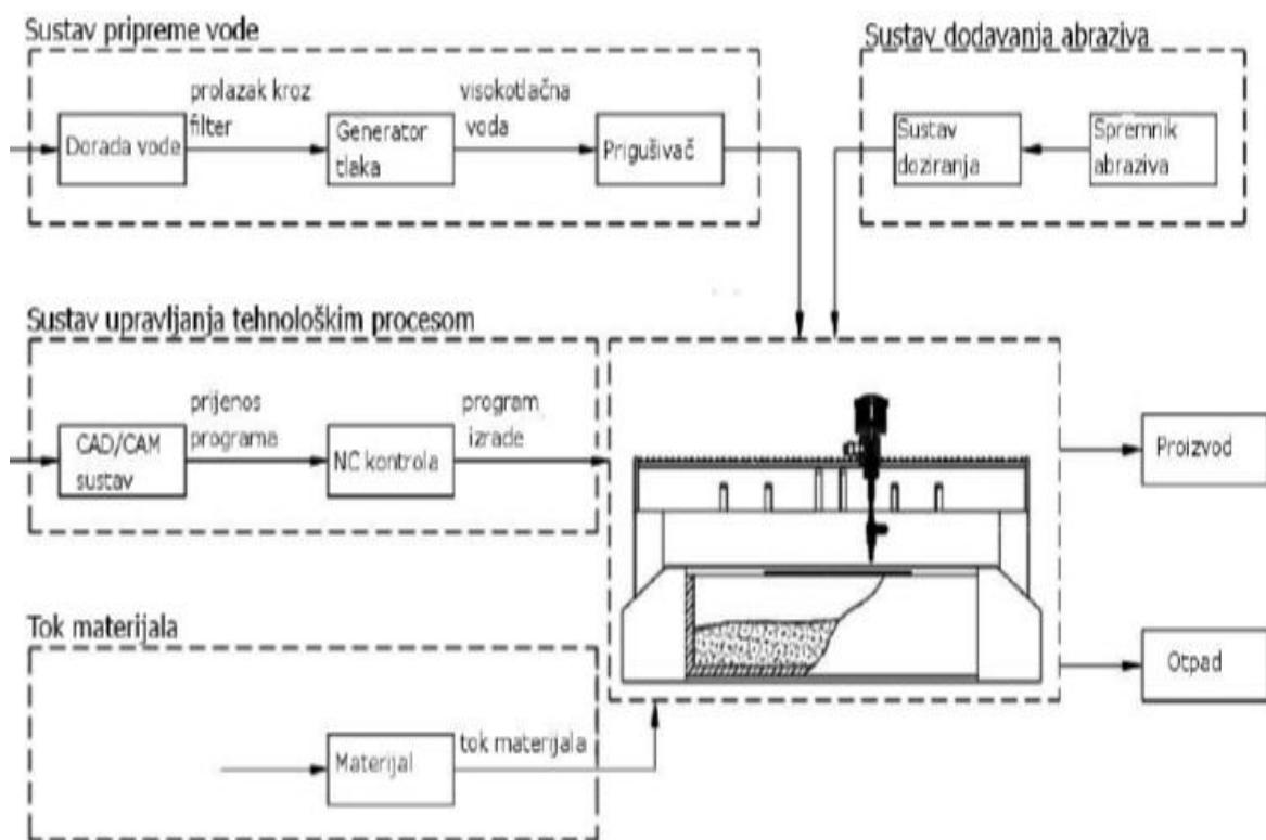
Slika 6. Tehnologija rezanja materijala abrazivnim vodenim mlazom
