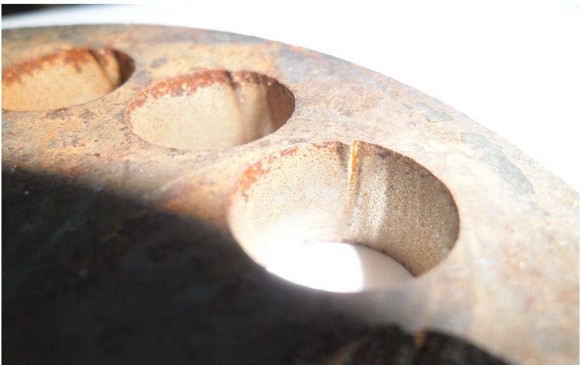
Slika 45. Pogreška nastala pri obradi promjera promjera 14 mm
