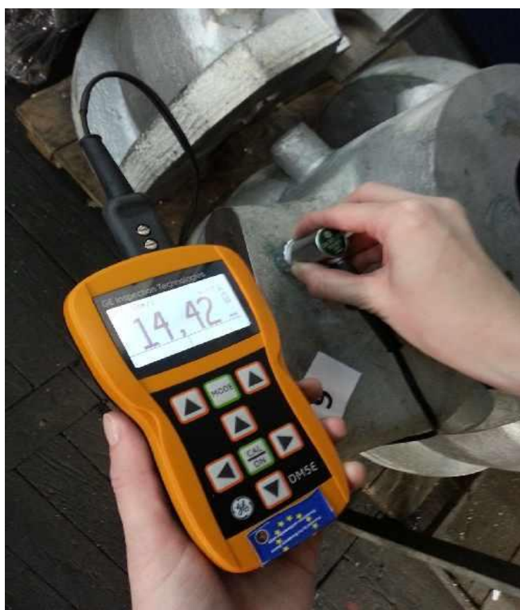
Slika 27. Mjerenje debljine stijenke odljevka ultrazvučnim uređajem.
