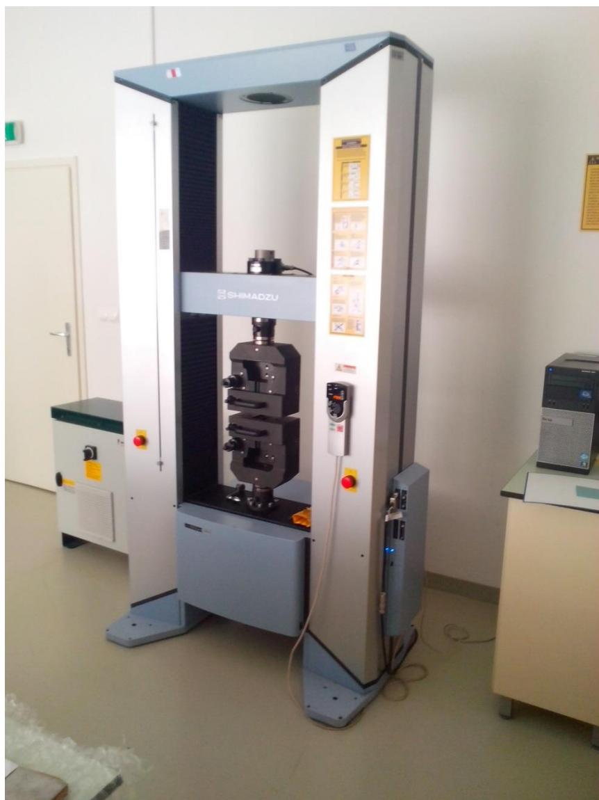
Slika 17. Kidalica Shimadzu AG-X
