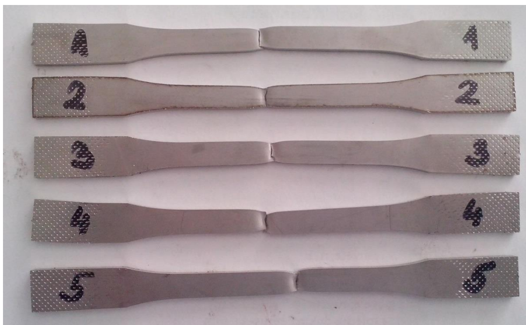
Slika 23. Epruvete nakon vlačnog ispitivanja
