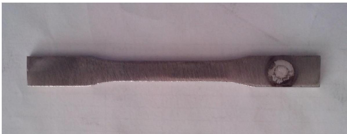
Slika 26. Izgled epruvete nakon ispitivanja tvrdoće po Brinell-u
