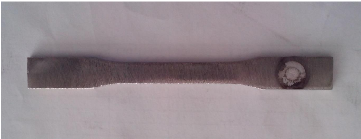
Slika 26. Izgled epruvete nakon ispitivanja tvrdoće po Brinell-u
