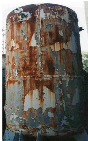
Slika 12. Primjer opće korozije vanjskih stijenki spremnika [10]
