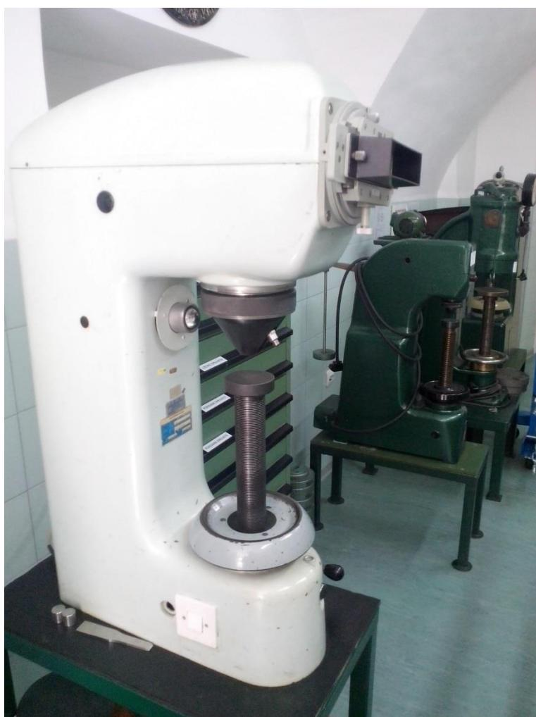
Slika 18. Tvrdomjer Brinell, Vickers
