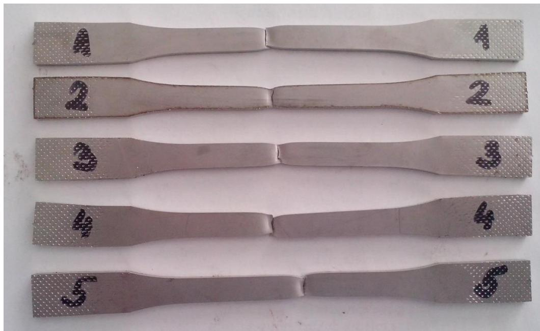
Slika 23. Epruvete nakon vlačnog ispitivanja
