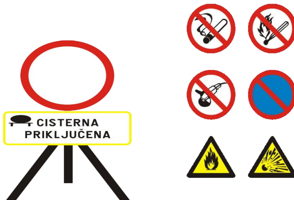
Slika 13. Vidljivi znakovi koji se postavljaju na pristupni put[13]
