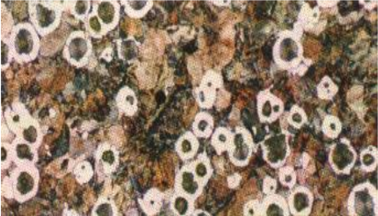
Slika 20. Mikrostruktura perlitnog nodularnog lijeva [7]
