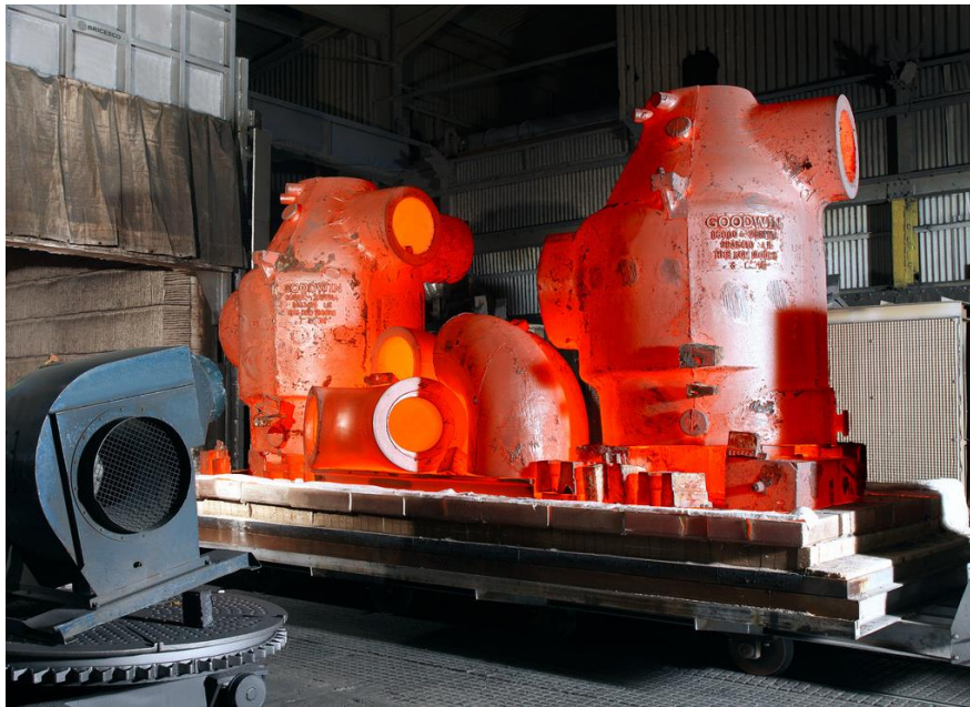
Slika 9. Čelični lijev nakon 12 sati toplinske obrade[5]
