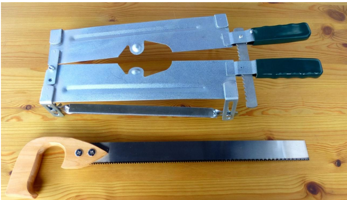
Slika 7: Stalak i pila za rezanje lubanja trofeja srnjaka
