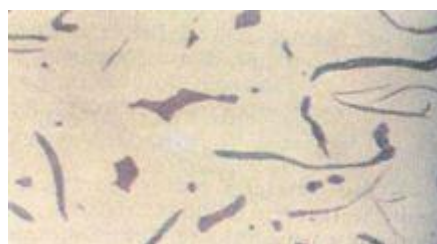
Fosfidni eutektik, nagrizano fericijanidom, povećanje 500X
