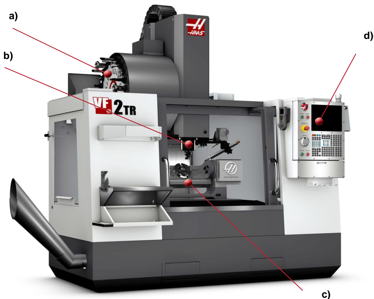
Slika 23. HAAS VF-2TR – a) standardni rotacioni izmjenjivač alata, b) vreteno, c) trunnion, d) ISO standardna G-kod programibilna operacijska jedinica
